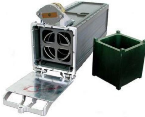
Figura 1.4. P-POD y un modelo de CubeSat de 1U
