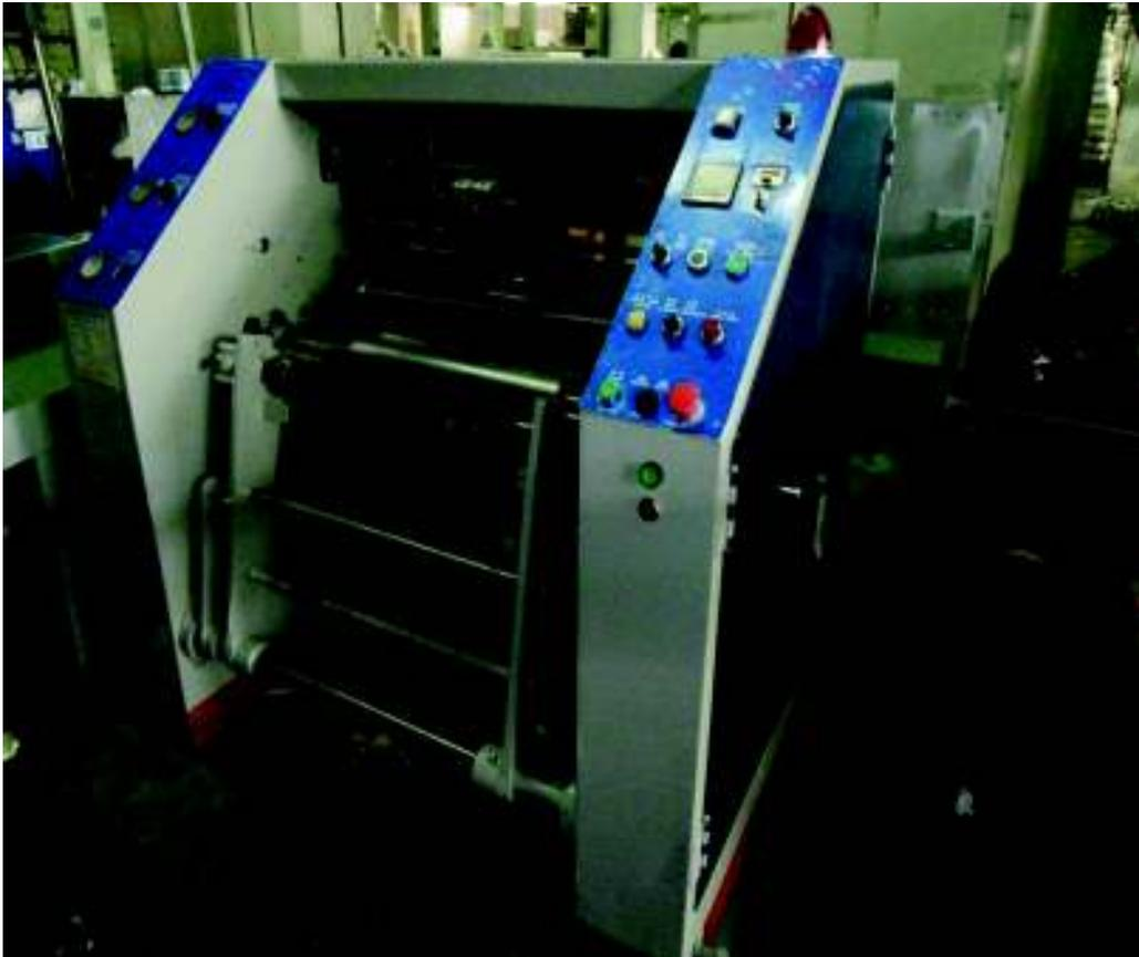
**A1.** Vista frontal máquina rebobinadora de lámina plástica, área de rebobinado principal centro, panel de mando neumático izquierda, panel de mando eléctrico derecha.
