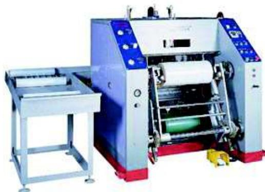
**Figura 18** Máquina rebobinadora de lámina plástica stretch film
