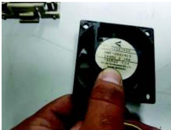
**Figura 49** Ventilador de Enfriamiento para Variador de Frecuencia
