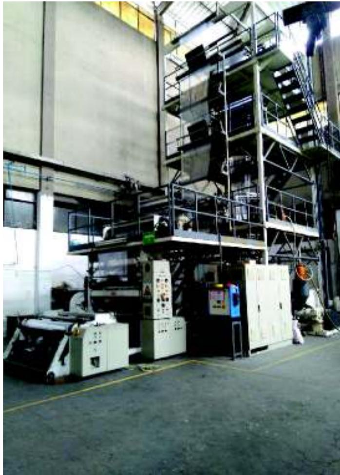
**Figura 4** Extrusora Tipo Burbuja
