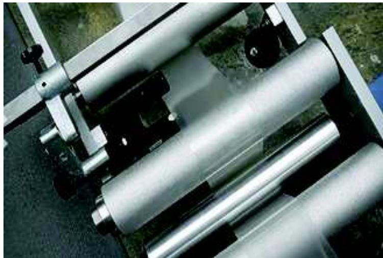
**Figura 12** Alineador de lámina plástica
