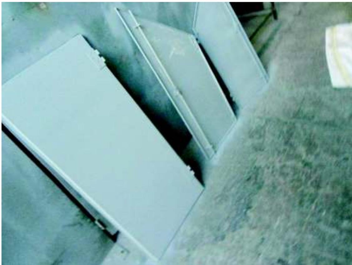
**A11.** Vista frontal de las puertas de sellado de la estructura de la Máquina Rebobinadora Strech Film, se presenta en el proceso de fondeado para luego aplicar la pintura esmalte para renovar el aspecto de la misma.
