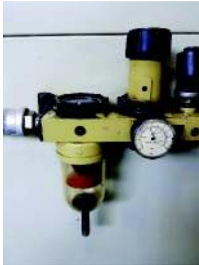
**Figura 55** Unidad de Mantenimiento Neumático
