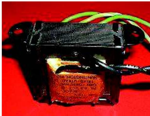
**Figura 33** Transformador
