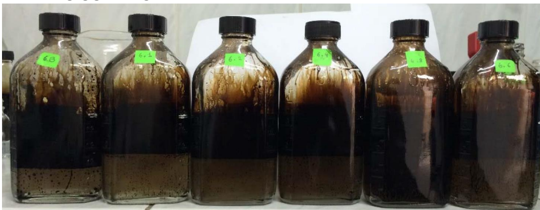
FIGURA 3.6 RESULTADOS PRUEBA DE COMPATIBILIDAD NÚMERO 2, ARENA U SUPERIOR
