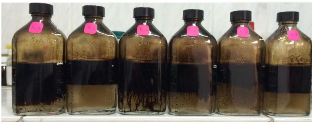
FIGURA 3.11 RESULTADOS PRUEBA DE COMPATIBILIDAD NÚMERO 3 ARENA U INFERIOR
