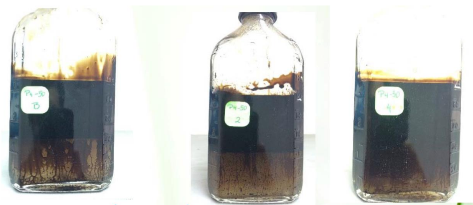
FIGURA 3.9 RESULTADOS PRUEBA DE COMPATIBILIDAD NÚMERO 1, ARENA U INFERIOR.
