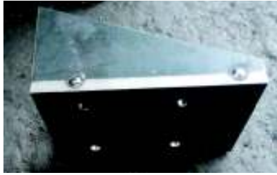
Figura 4.20. Construcción del soporte del cilindro de empuje. (Fuente: propia)
