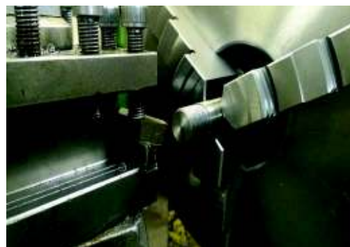
Figura 4.3. a) Material base y plano a detalle vástagos. b) Proceso de cilindrado del vástago. (Fuente: propia)
