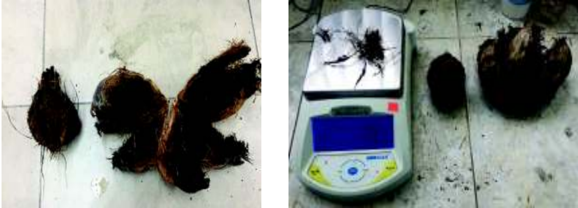
Figura 4.33. a) Fibra y coco bruto. b) Pesaje del sobrante y fibra. (Fuente: propia)
