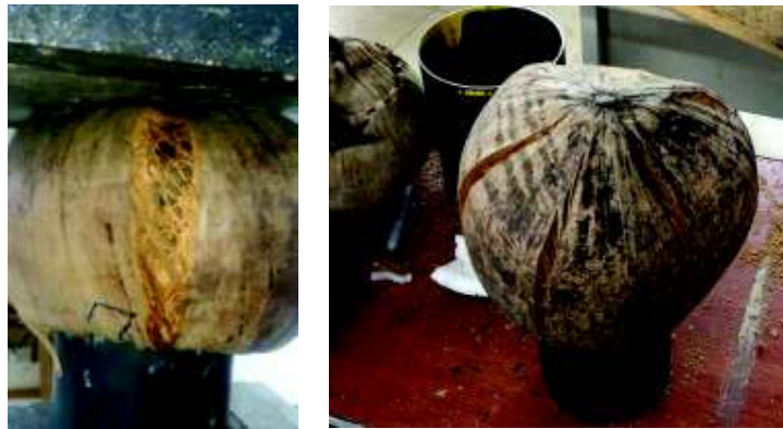
Figura 3.13. Desgarro de la fibra. (Fuente propia)
