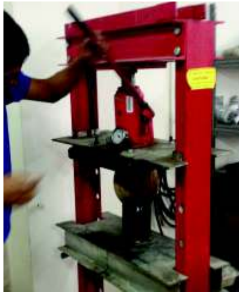
Figura 3.11. Ensayo con cilindros dentados. (Fuente: propia)
