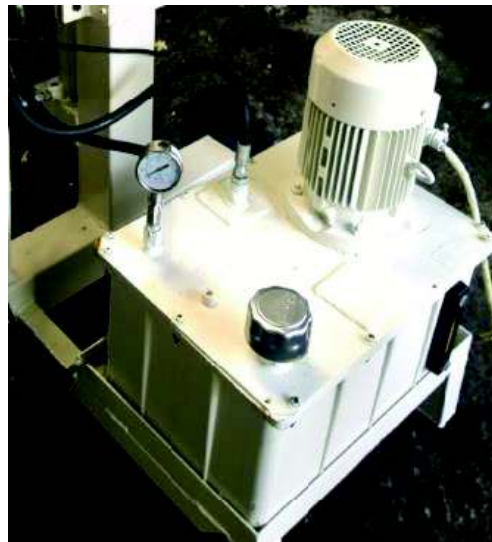
Figura 4.28. Centralina hidráulica. (Fuente: propia)
