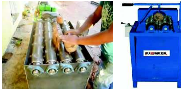
Figura 1.13. Descortezadora con rodillos dentados. (Fuente: (Lara, YOUTUBE, 2012))
