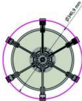
Figura 3.28. Circunferencia mayor formado por las palas. (Fuente: propia)
