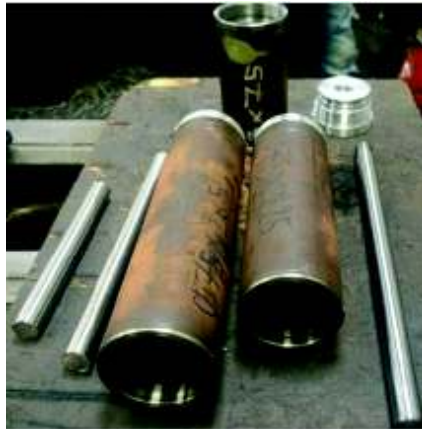
Figura 4.22. Elementos constitutivos de los cilindros. (Fuente: propia)
