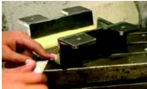
Figura 4.16. Guía deslizante con montaje de las guías de duralón. (Fuente: propia)
