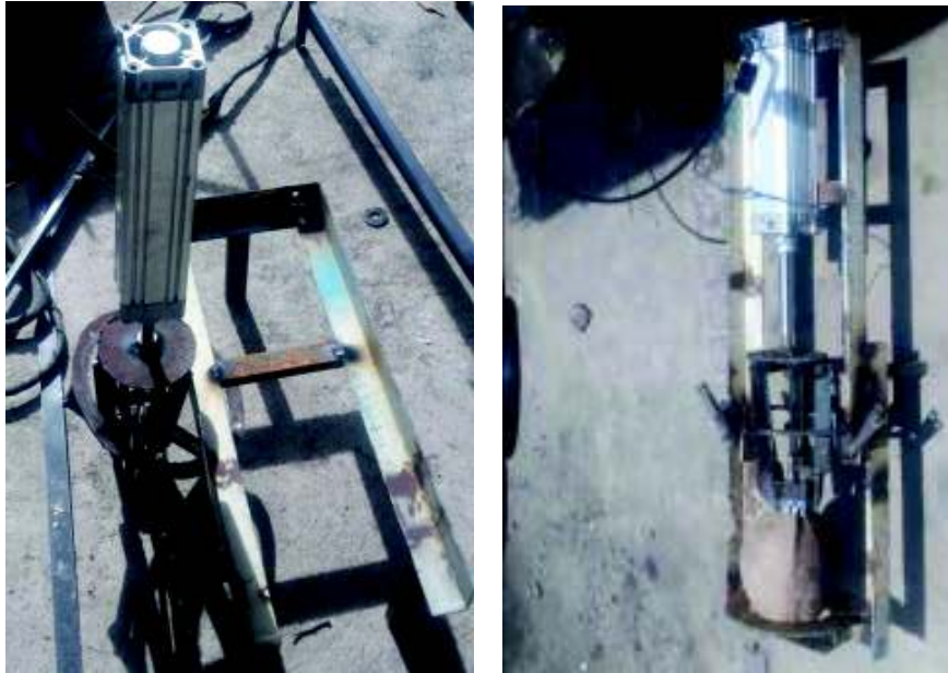
Figura 3.7. Montaje del cilindro superior para el descortezado. (Fuente: propia)
