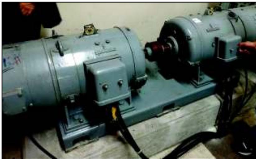
**Figura 56.** Estado del grupo Motor DC – Generador AC al inicio del trabajo
