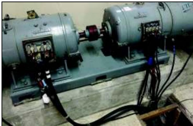
**Figura 63.** Señalización de Cables en Terminales del Equipamiento Ward Leonard
