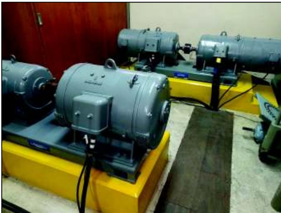
**Figura 97.** Estado de Entrega del Equipamiento Ward Leonard al Laboratorio de Máquinas Eléctricas
