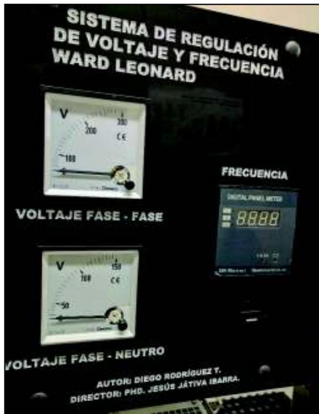
**Figura 100.** Nuevo Panel de Mediciones que Permite Regulación Manual In Situ
