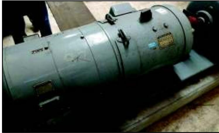
**Figura 72.** Generador Sincrónico del Sistema Ward Leonard
