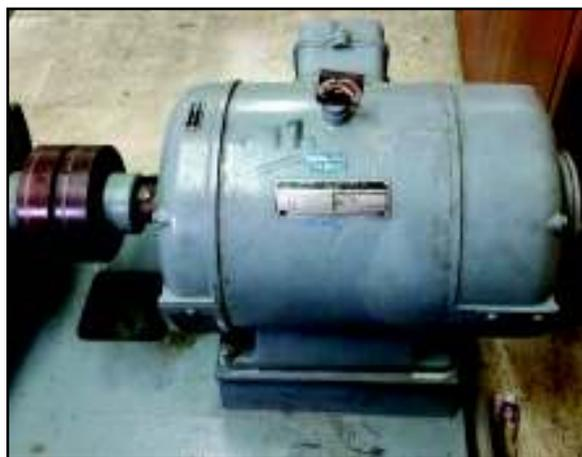
**Figura 67.** Motor Trifásico de Inducción del Sistema Ward Leonard
