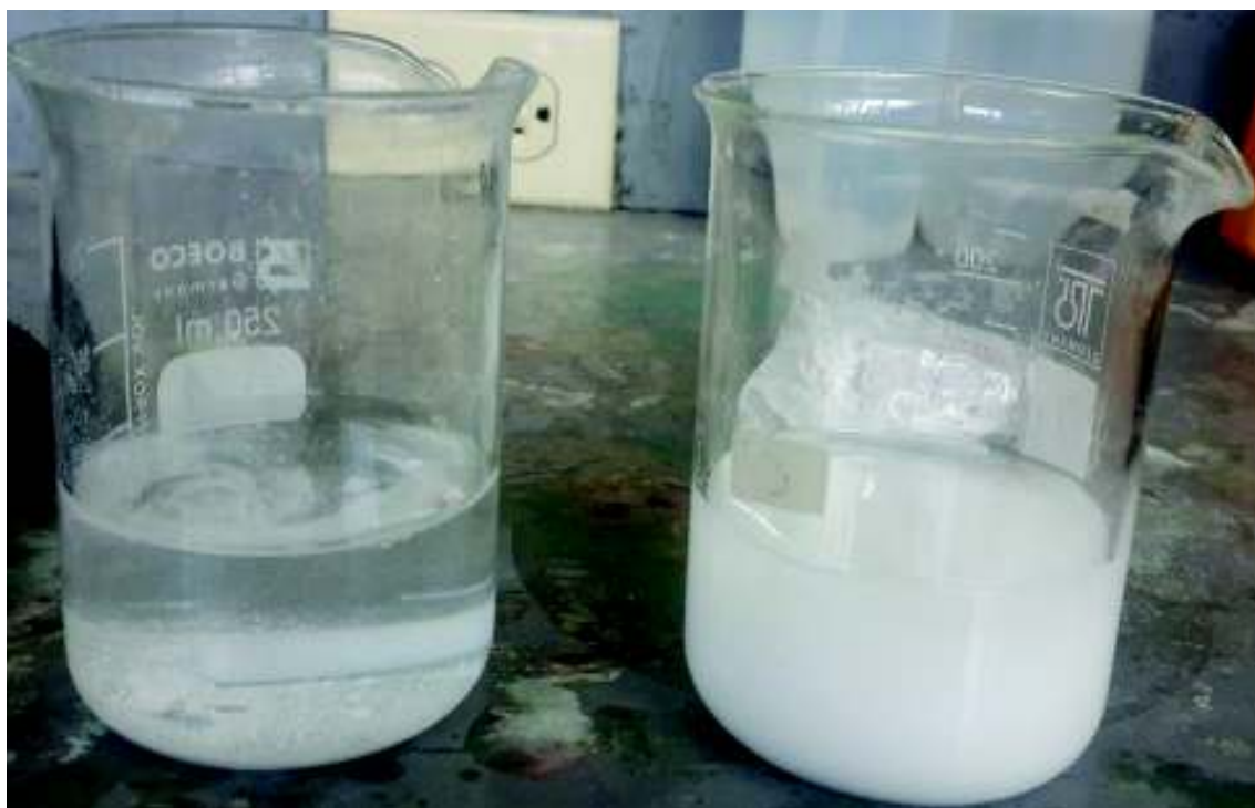
Figura 3. 3. Dispersión en el agua: Izq. \text{TiO}_2 técnico. Der. \text{TiO}_2 alimenticio
