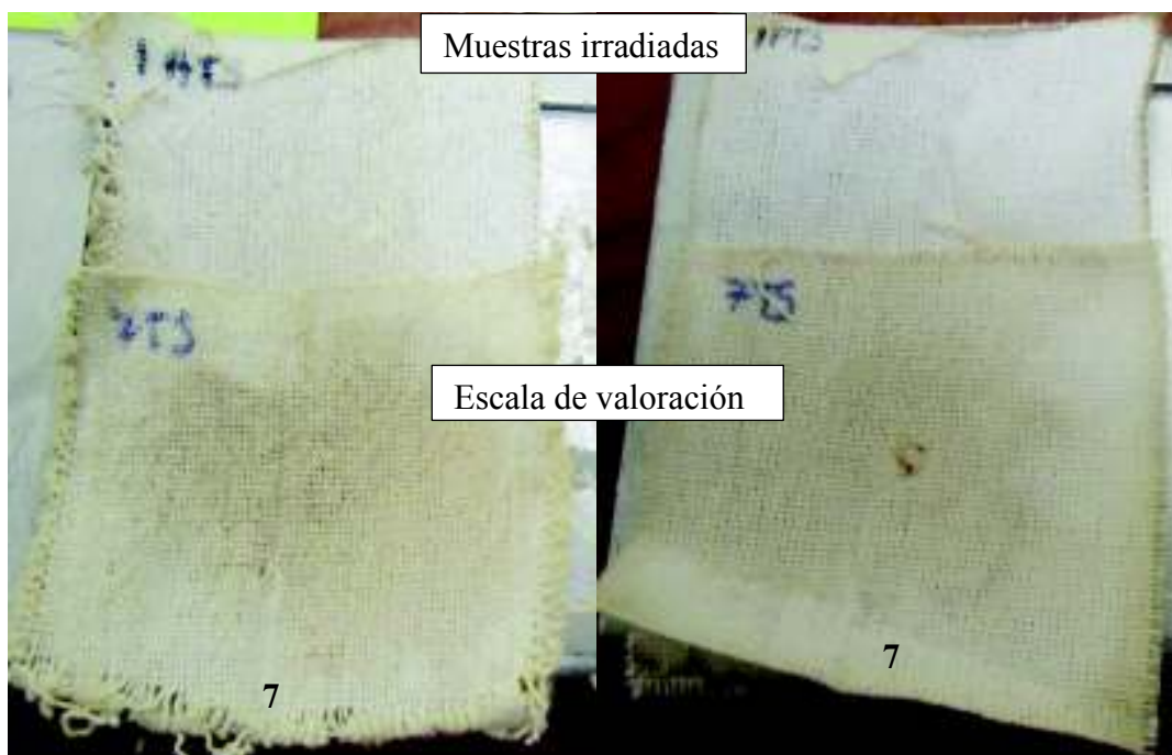
Figura 3. 30. Parte superior. Telas expuestas 24 horas de irradiación UV en la cámara de xenón. Parte inferior. Escala de valoración con valor de 7 de la macha de solución de café
