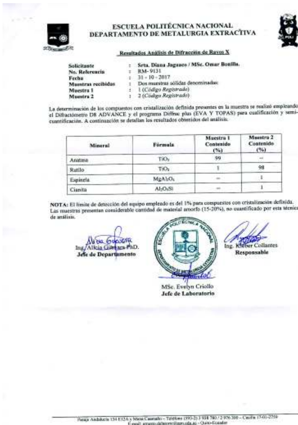
Figura AII. 1. Resultado del tipo de cristalización de los dióxidos de titanio alimenticio y técnico
