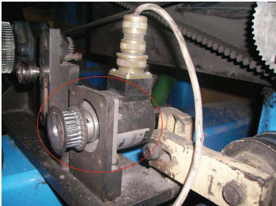
**Figura 4.4** Encoder ABZ de 100 pulsos, sin banda de acoplamiento al eje
