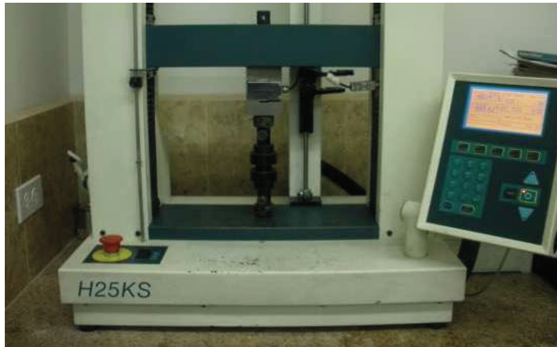
Figura AV.1. Ensayo de compresión realizado en una probeta de biocarbón
