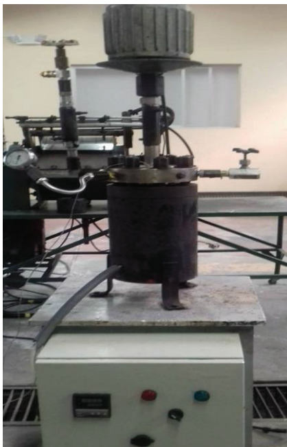
Figura 2.1. Reactor de alta presión utilizado para realizar la torrefacción
