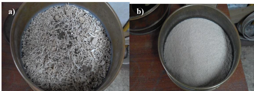
Figura AI.2. a) Partículas de aserrín retenidas en la malla 16; b) partículas de aserrín que pasaron al fondo del tamiz vibratorio
