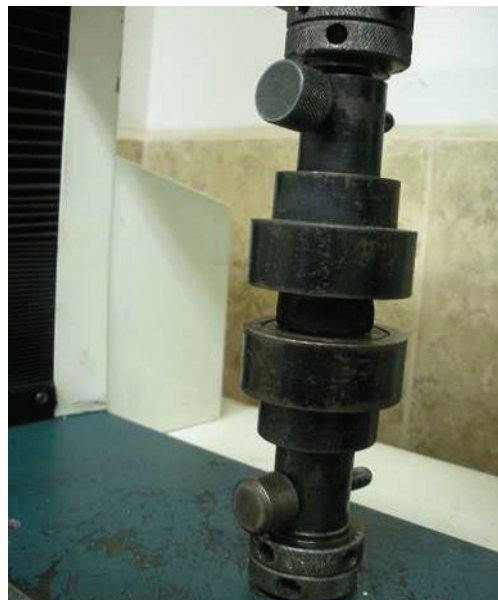
Figura AV.2. Compresión de la probeta de biocarbón durante el ensayo
