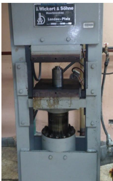
Figura 2.2. Prensa hidráulica utilizada para la elaboración de pellets
