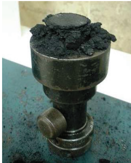
Figura AV.3. Probeta de pellet de biocarbón luego del ensayo de compresión
