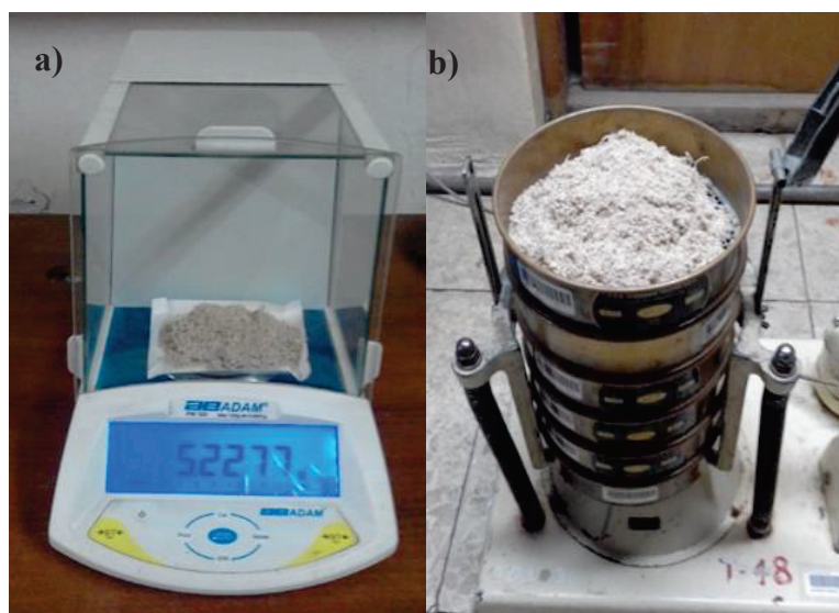
Figura AI.1. a) Balanza analítica con la muestra de aserrín de balsa; b) tamiz vibratorio con la muestra de aserrín de balsa.
