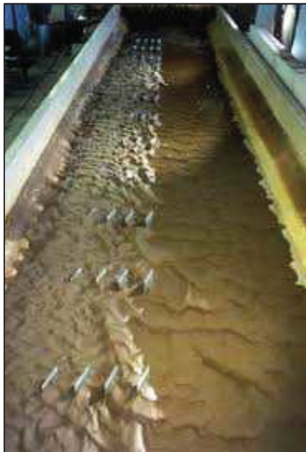
FIGURA 1.4 MODELACIÓN CON PANELES: TRAMO RECTO DEL CANAL.
