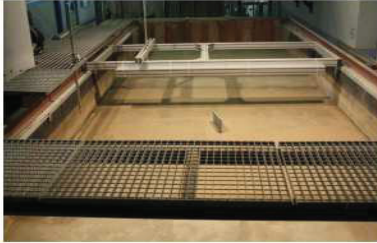
FIGURA 3.9 TRAMO CENTRAL DEL CANAL CON EL PANEL.
