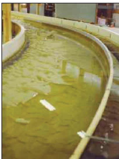
FIGURA 1.2 CANAL CURVO: MODELACIÓN SIN PANELES SUMERGIDOS.
