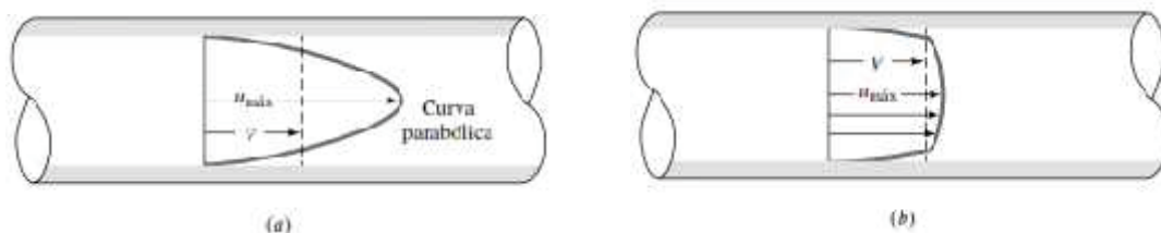
FIGURA 2.35 PERFILES DE VELOCIDAD: a) LAMINAR, b) TURBULENTO.
