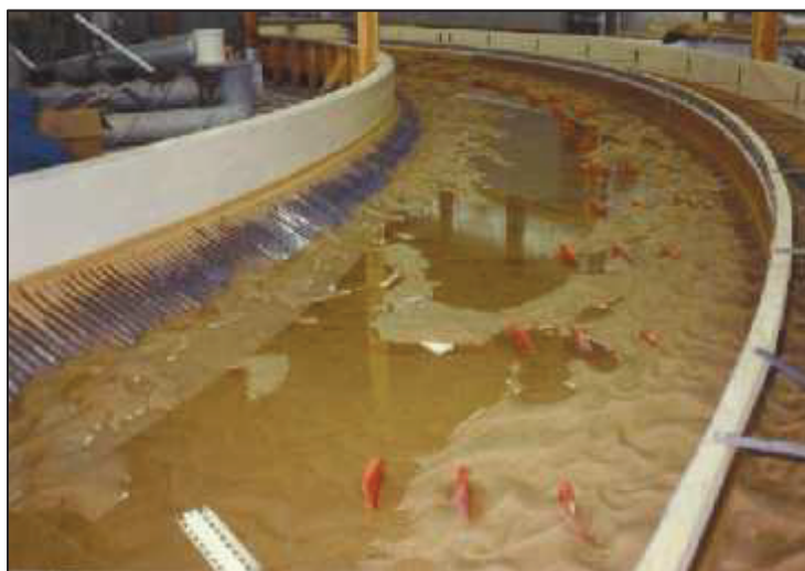
FIGURA 1.3 CANAL CURVO: MODELACIÓN CON PANELES SUMERGIDOS.
