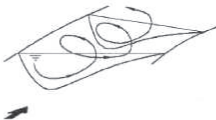
FIGURA 2.11. CORRIENTE SECUNDARIA, FLUJO HELICOIDAL EN EL FONDO.
