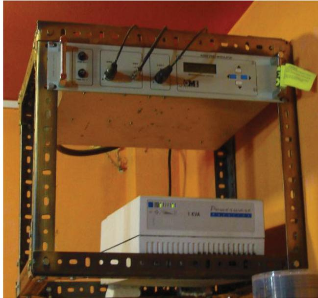
Figura 3.28 Modulador OMB y regulador de voltaje
