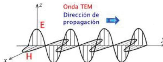
Figura 1.17 Polarización onda transversal electromagnético [16]
