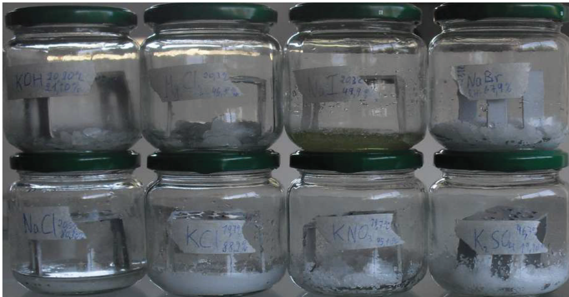
Figura 3.6: Sales químicas: Hidróxido de Potasio, Cloruro de Magnesio, Yoduro de Sodio, Bromuro de Sodio, Cloruro de Sodio, Cloruro de Potasio, Nitrato de Potasio y Sulfato de Potasio (De izquierda a derecha).
