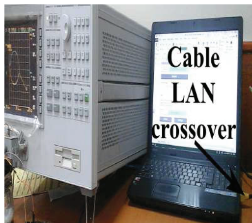
Figura 3.8: Espectrómetro de Impedancia conectada a la "laptop" a través del cable LAN "crossover".
