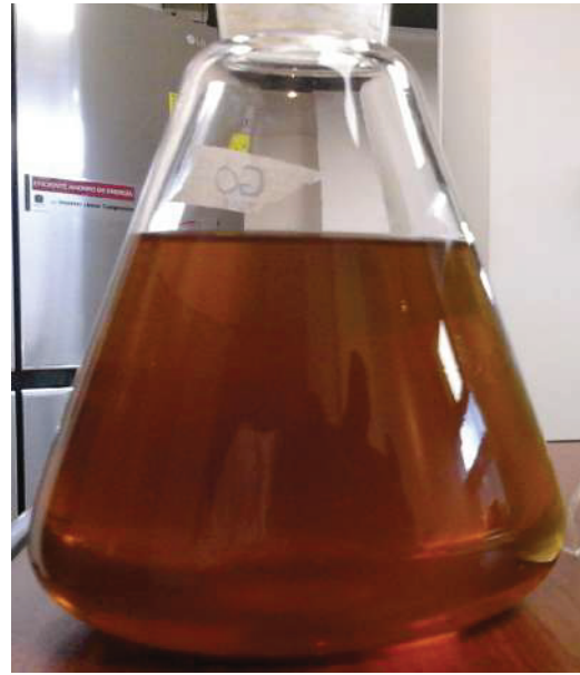
Figura 3.3: Óxido de grafeno en 2-propanol.
