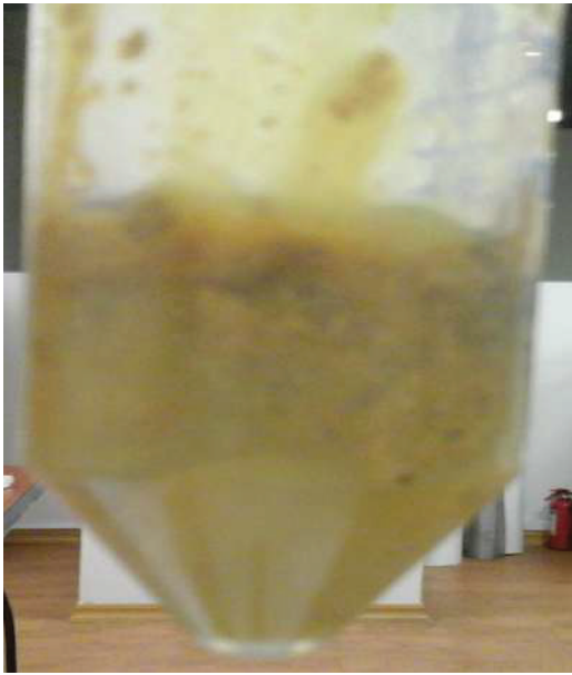
Figura 3.2: Óxido de grafito en polvo lavado
