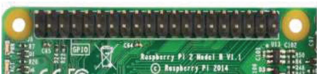
Fig. 1.1 Ubicación de los pines en la placa
