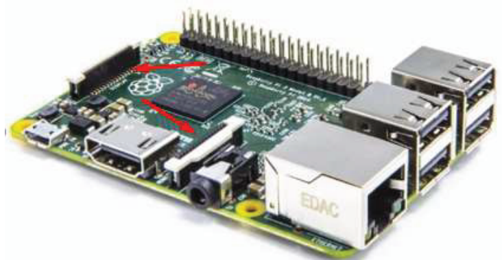
Fig. 4.7 Raspberry Pi2 modelo B
