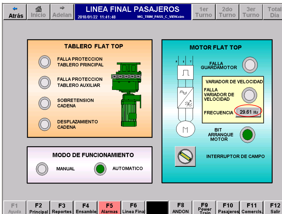
Figura 4.13 Muestra valor de Frecuencia del Variador de velocidad que controla el motor del Flat Top en la Línea de Pasajeros
