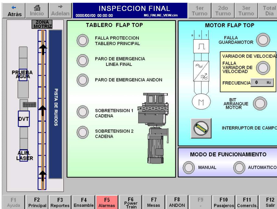
Figura 3.142 Pantalla de Monitoreo para Estado y Fallas del Flat Top de Inspección Final
