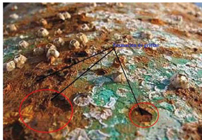
Figura 2.5. Ejemplo de Corrosión Microbiológica
