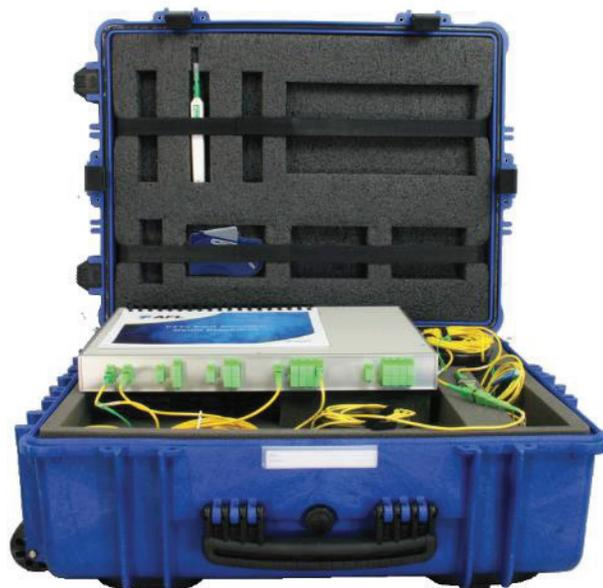
**Figura 4.9** Kit para simulación de redes PON (FTTx) <sup>[114]</sup>
