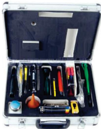
**Figura 4.11** Kit de herramientas para trabajos con fibra óptica
