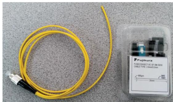
**Figura 4.61** Conectorización de un pigtail
