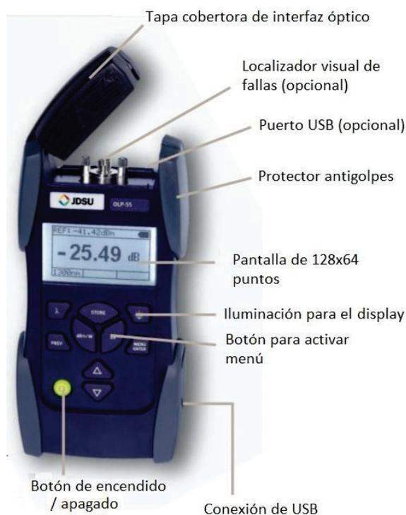
**Figura 2.7** Medidor de potencia óptica JDSU OLP-55 <sup>[96]</sup>
