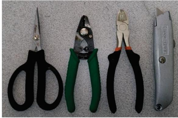
**Figura 4.49** Herramientas para preparar un cable de fibra óptica: tijeras para kevlar, pelador de revestimientos y buffer, alicate de corte y navaja multiuso
