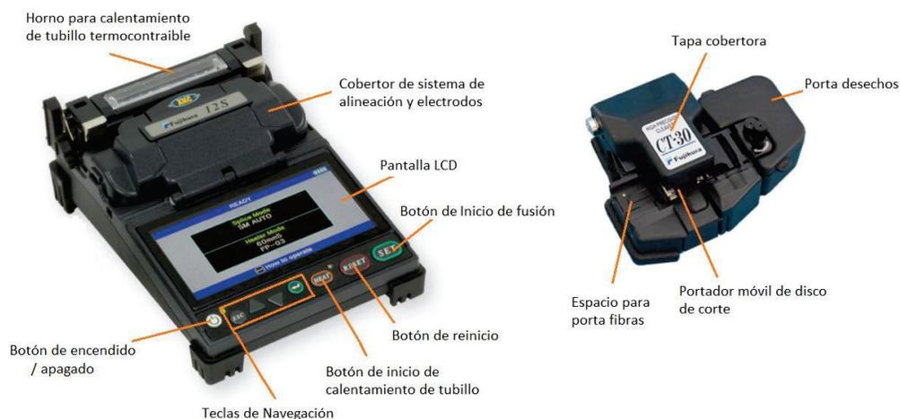
**Figura 4.45** Fusionadora Fujikura 12s y cortadora de precisión CT-30 <sup>[99]</sup> <sup>[100]</sup>
