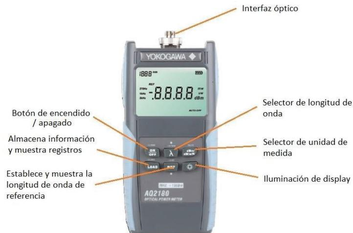
**Figura 4.3** Medidor de potencia óptica (OPM) YOKOGAWA – AQ2180 [95]
