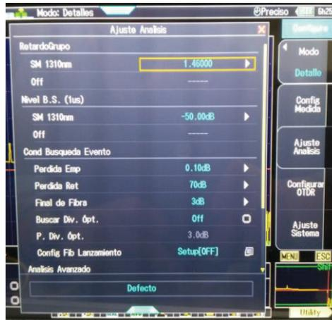
**Figura 4.34** Configuración del OTDR en modo “Detalle”
