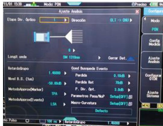
Figura 4.35 Configuración del OTDR en modo “PON”
