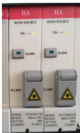
**Figura 2.12** Módulos OSICS TLS, generador WDM en banda L y banda C
