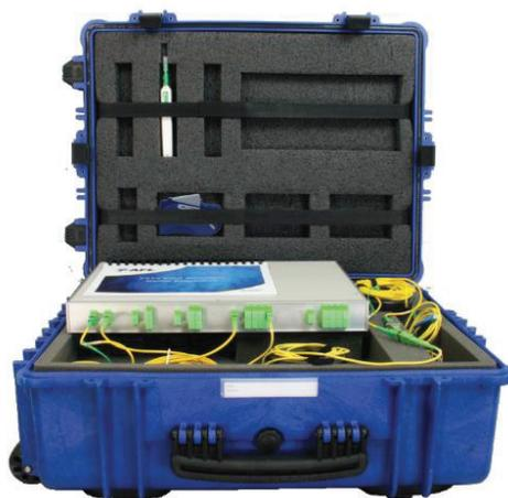
**Figura 2.23** Kit para simulación de redes PON (FTTx) <sup>[114]</sup>
