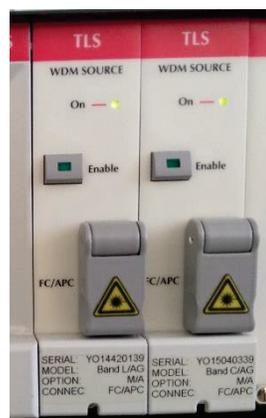
**Figura 4.116** Módulos OSICS TLS, generador WDM en banda L y banda C
