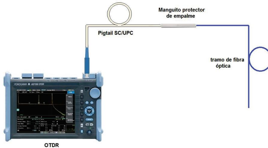
**Figura 4.67** Red para probar el empalme de fibra óptica
