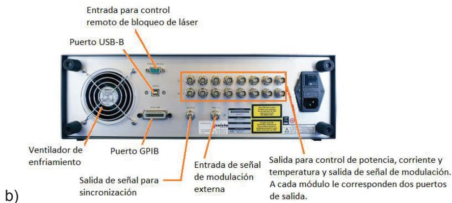
**Figura 2.11** Plataforma Multifunción OSICS a) vista frontal y b) vista posterior <sup>[102]</sup>
