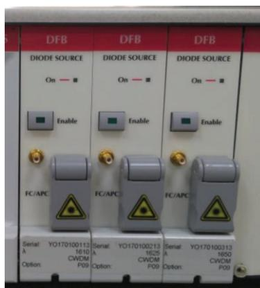
**Figura 2.13** Módulos OSICS DFB de 1610 nm, 1625 nm y 1650 nm.
