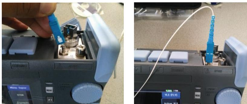
**Figura 4.42** Conexión de pigtail de prueba en el puerto de salida de la fuente de luz visible (diámetro de férula típico de 2.5 mm)
