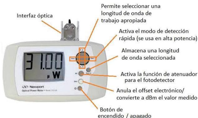
**Figura 2.5** Medidor de potencia óptica Newport 1916-C <sup>[92]</sup>
