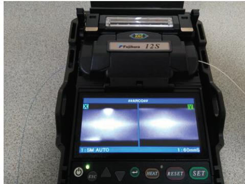
Figura 4.58 Fusión de las fibras ópticas
