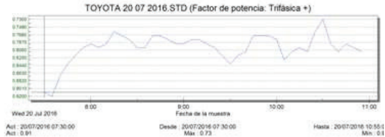
Figura 2.23. Medición de factor de potencia de la planta.
