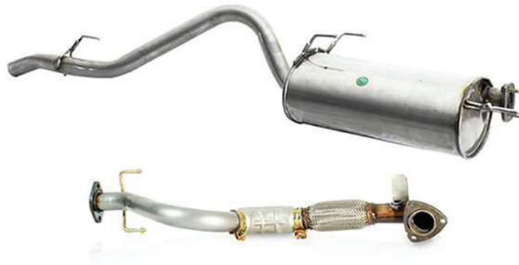
Figura 2.4a. Sistema de escape automotriz.
