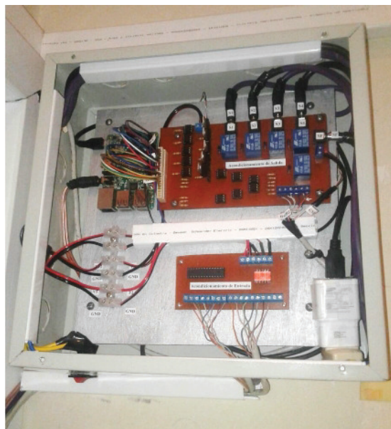
Figura 2.17 Disposición Interna de la caja de protección
