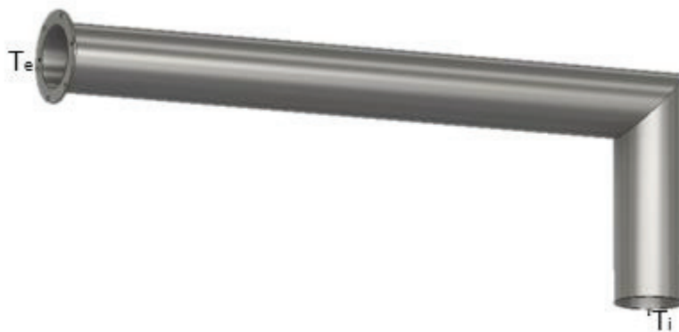
Figura 4.22. Análisis de pérdida de temperatura en la tubería. (Fuente: Propia, 2017)
