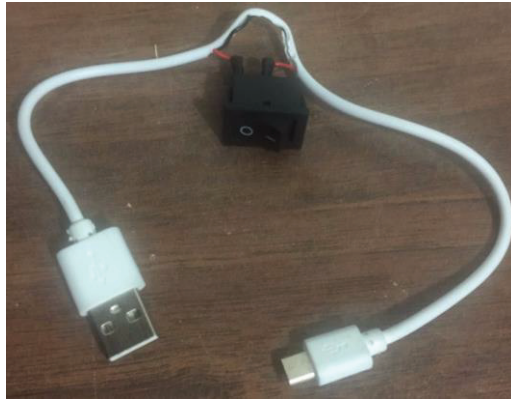
Figura 2.50 Cable de conexión Batería - Raspberry Pi 2B.
