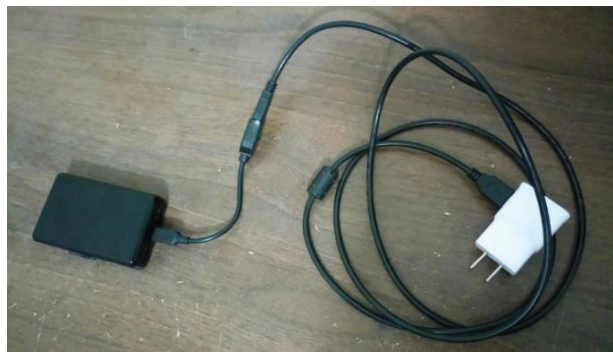
Figura 2.51 Cable de conexión Batería – Cargador.
