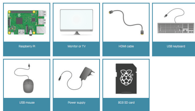
Figura 2.12 Periféricos básicos para la configuración de la Raspberry Pi 2B [61].
