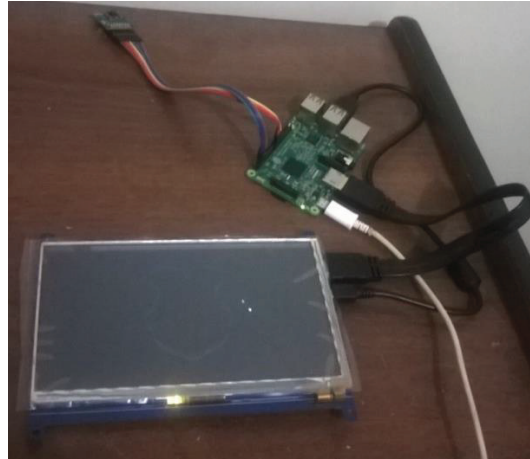
Figura 2.20 Conexión de cámara térmica y pantalla con la Raspberry Pi 2B.
