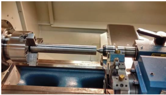
Figura 3.2 Proceso de montaje de material base AISI 1018 para maquinado del eje de transmisión.
