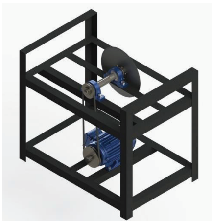
Figura 2.28 Esquema del bastidor con perfil L 2 \times 2 \times \frac{1}{8} [in] con alojamiento para motor y sistema de sierra de corte. Fuente: (Propia)
