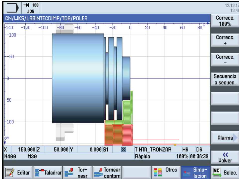
Figura 3.7 Simulación del código iso para la polea conducida.
