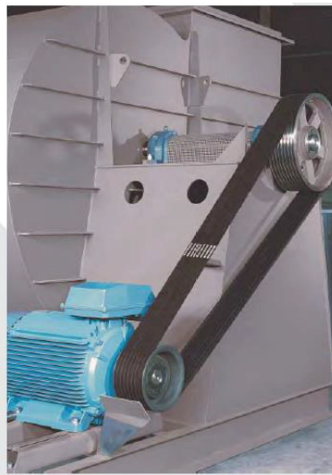
Figura 2.5. Sistema de transmisión por banda y poleas. Fuente: (OPTIBELT, 2017)
