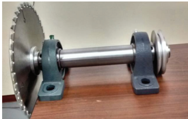
Figura 4.2 Montaje de la sierra circular de corte final de los elementos fabricados en CNC y de los elementos seleccionados de catálogo.
