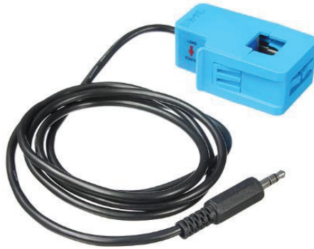
Figura 2.21. Sensor de Corriente SCT-013-030 (Fuente: https://electronilab.co [35])
