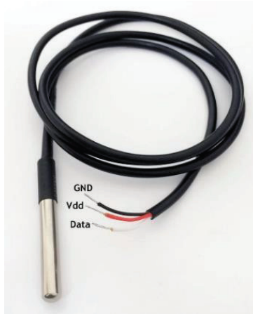
Figura 2.19. Sensor Temperatura DS18B20 (Fuente: http://tienda.bricogeek.com [33])
