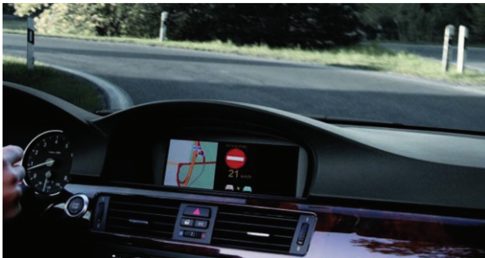
Figura 1.4 Señal de Advertencia de sentido contrario [1].
