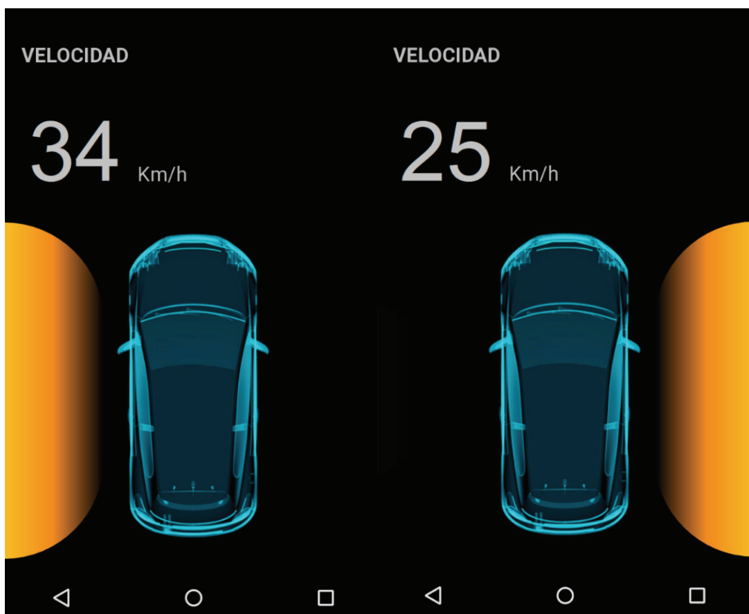
Figura 4.4 Interfaz de alerta para ángulo ciego en el lado derecho e izquierdo del vehículo.
