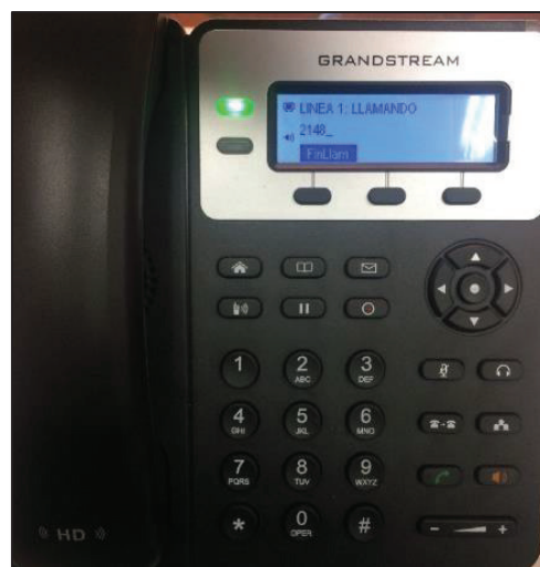
Figura 4-11 Llamada desde teléfono IP a Softphone
