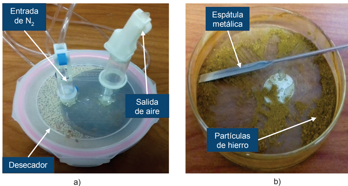
Figura 2.2. a) Dsecador modificado para mantener una atmósfera de nitrógeno y b) partículas de hierro sólidas raspadas con una espátula metálica
