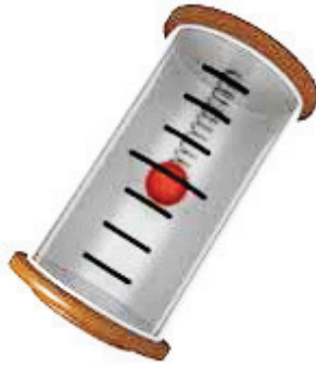
Figura 1.3. Mecanismo de un acelerómetro mecánico [7].
