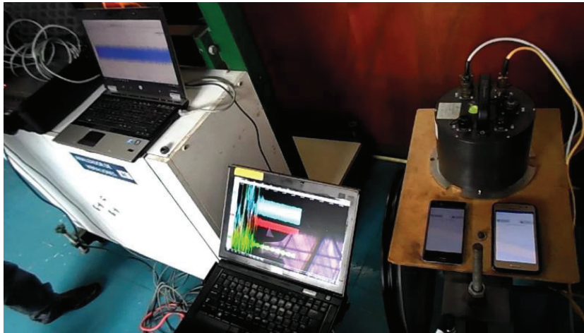
Figura 3.9. Pruebas con los dos celulares de prueba y el sensor Guralp CMG-5TDE
