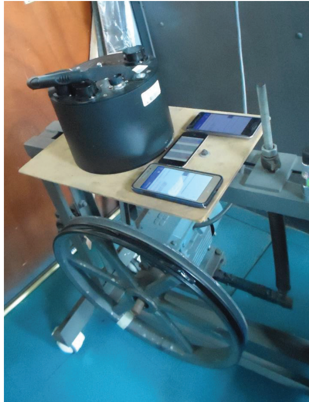
Figura 3.8. Ubicación de los sensores sobre el generador de vibraciones.
