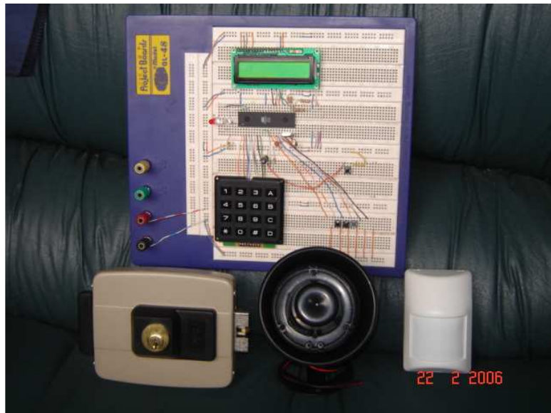
Figura 3.6. Elementos que conforman un sistema de seguridad.
