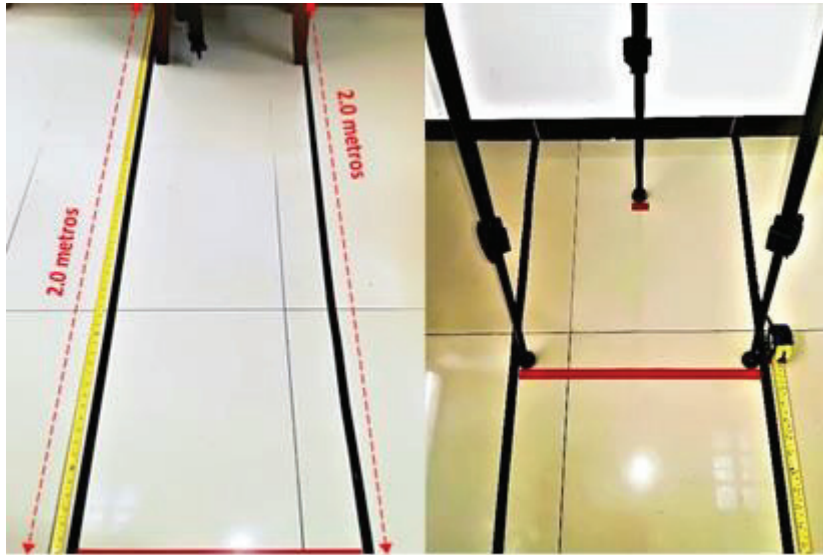
Figura 2.5. Líneas guías para posicionamiento de silla y trípode (Fuente: Propia)
