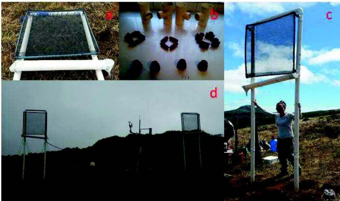
FIGURA 3.4 A) SUPERFICIE COLECTORA DE NEBLINA, B) ACCESORIOS PVC, C Y D) COLECTORES ESTÁNDAR DE NEBLINA INSTALADOS EN LA ESTACIÓN CLIMÁTICA A 600 MSNM EN LA ISLA SAN CRISTÓBAL
