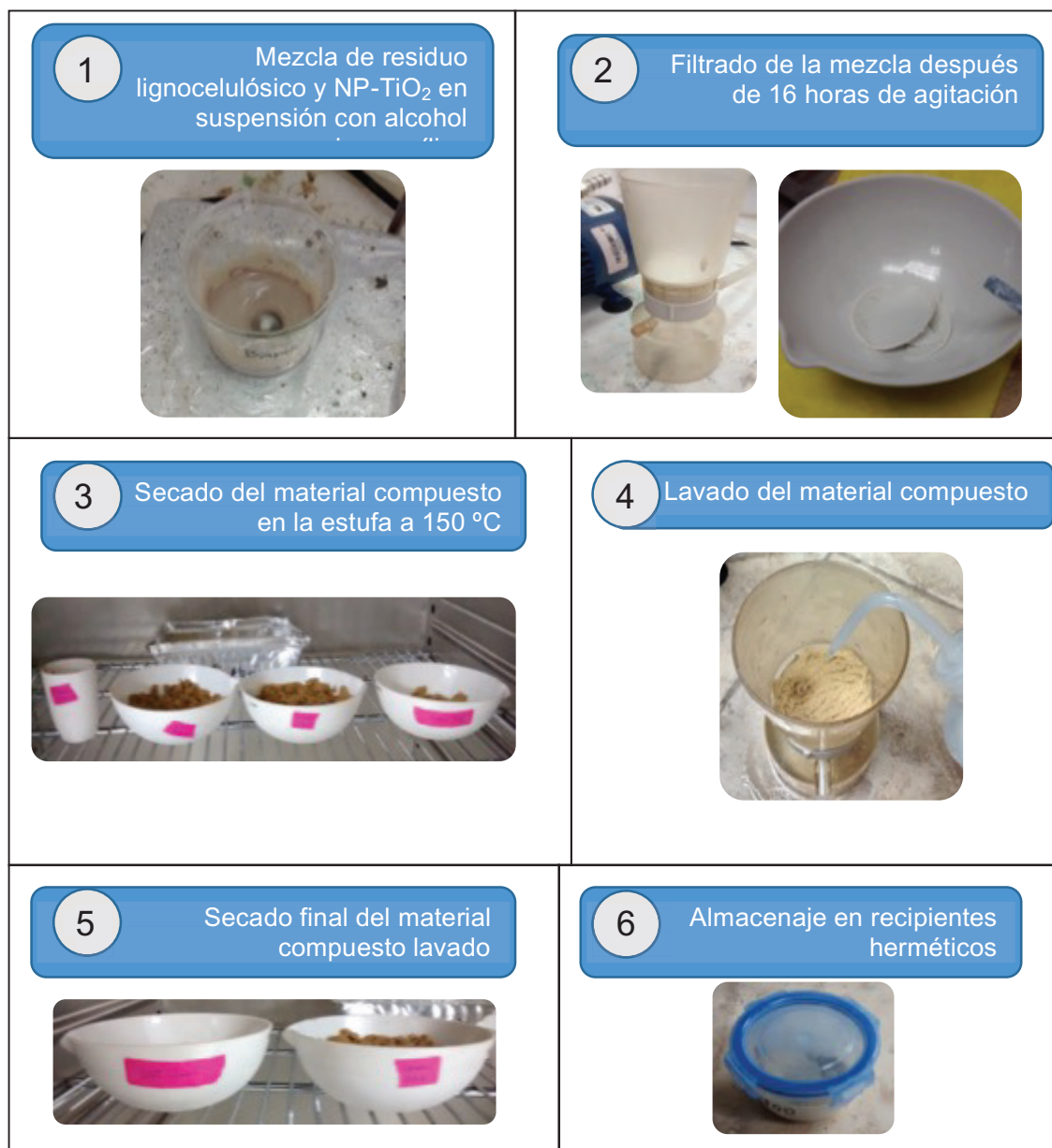
Figura AI. 2 Esquema fotográfico de la impregnación de NP-TiO 2 en los residuos lignocelulósicos
