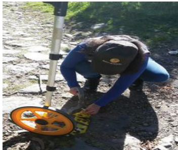
Figura 10: Colocación de estacas y rueda de medición.
