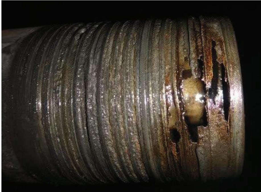
Figura 2.8. Rosca lavada o desintegrada. Fuente: Tecpetrol, 2017
