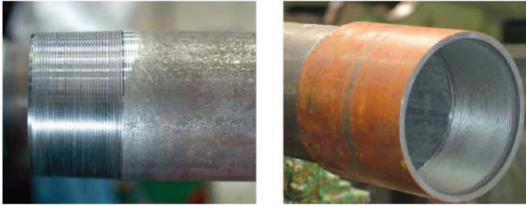
Figura 2.1. Pin, caja y rosca de una tubería de producción. Fuente: http://www.tenaris.com/shared/documents/files/cb290.pdf
