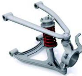
Figura 1.3. Suspensión de brazo doble A.
