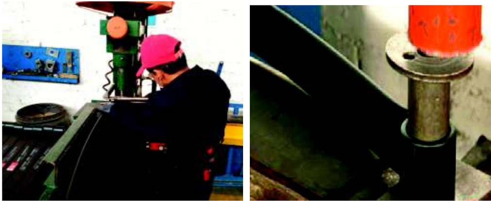
Figura 1.16. Colocación de bujes en las hojas de resortes.
