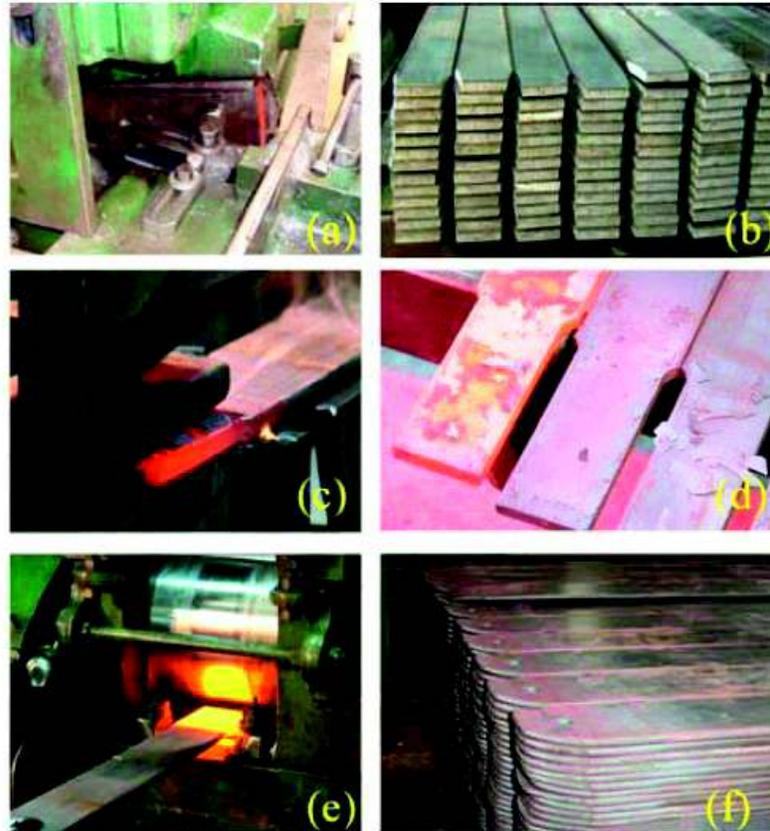
Figura 1.7. (a) Proceso de diamantado. (b) Hojas diamantadas. (c) Proceso de Fresado en caliente. (d) Hojas fresadas en caliente. (e) Proceso de laminado. (f) Hoja laminada en el extremo.
