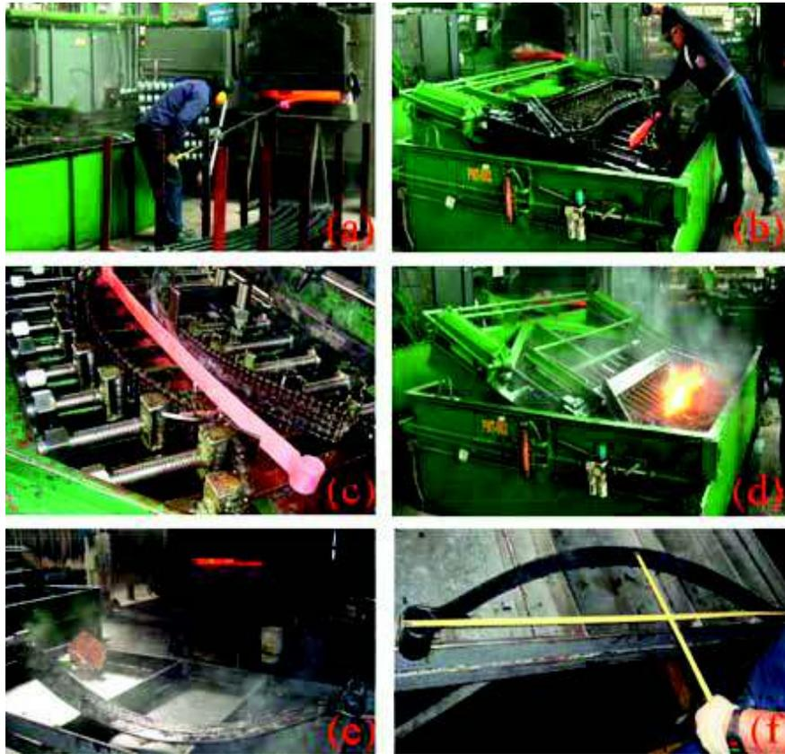
Figura 1.10. (a) Extracción de la hoja del horno. (b) Colocar hoja en prensa. (c) Activar la prensa. (d) Hoja sumergida en aceite. (e) Hoja realizada su curvatura. (f) Verificación de flecha de la hoja.
