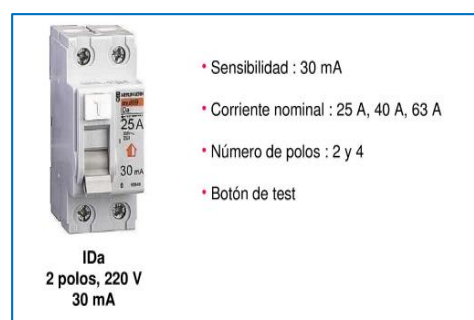
Figura .1.5 Características del interruptor diferencial [17]
