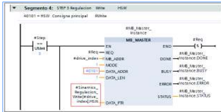
Figura 2.66. Bloque MB_MASTER para la escritura de la consigna principal
