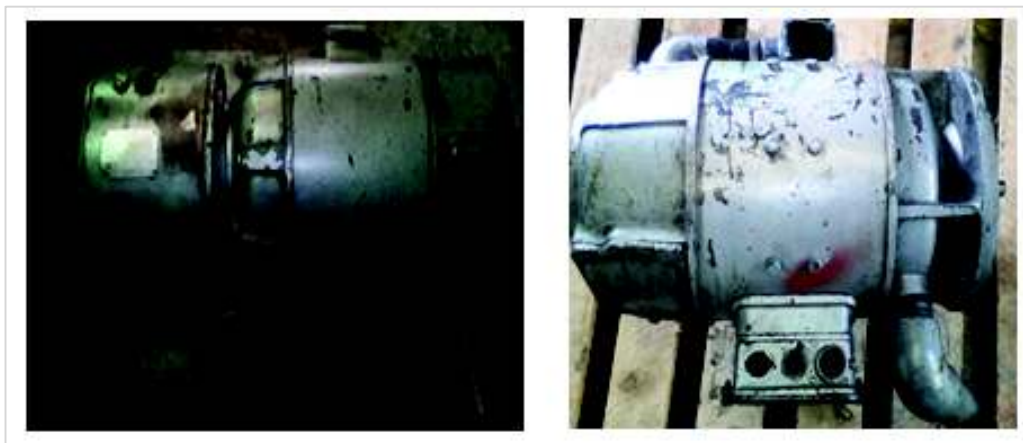
Figura 1.22. Motores de CC de 2,1 kW y 2,8 kW respectivamente.
