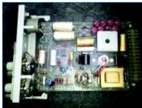
Figura 1.18. Tarjeta de regulador de campo para los tiristores FV71-1 [1]
