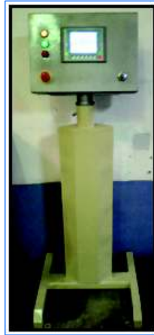
Figura 2.68. Tablero de Mando y visualización del HMI
