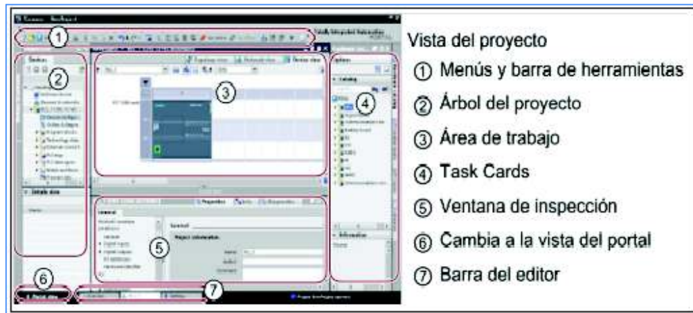
Figura 2.33. Vista del Proyecto [3]
