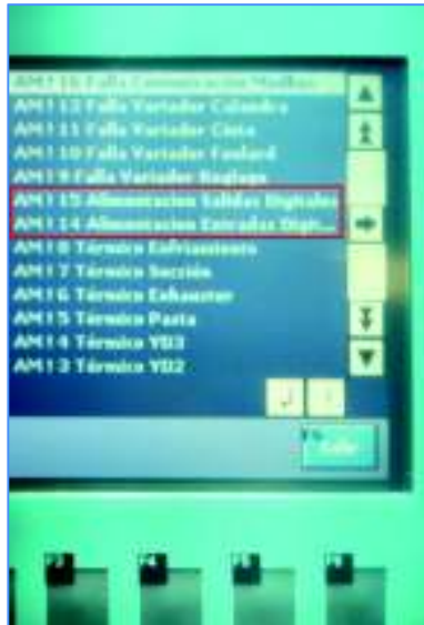
Figura 3.4. Lista de alarmas entradas y salidas digitales desplegadas en la HMI.
