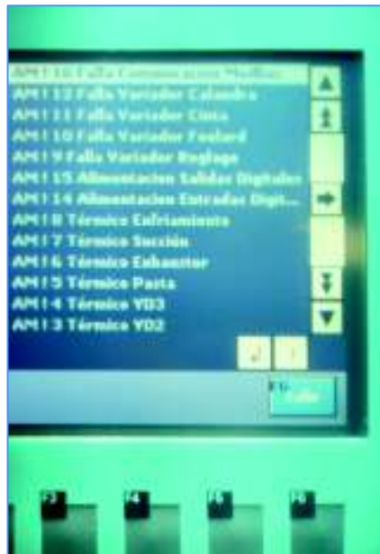
Figura 3.3. Lista de alarmas desplegadas en la HMI.
