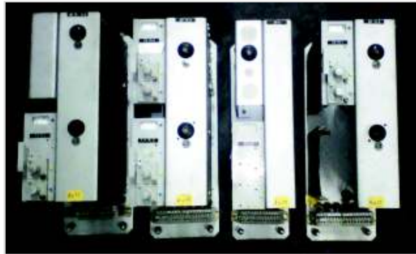
Figura 1.17. Módulos reguladores de campo de la serie de tipo FV71
