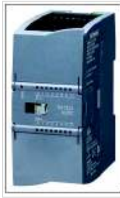
Figura 2.12. Módulo de E/S 8 in 120-230VAC/ 8 salidas Relay [3]
