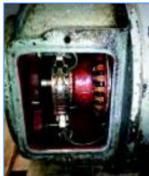
Figura 1.24. Sistema de colector escobillas de los motores CC.
