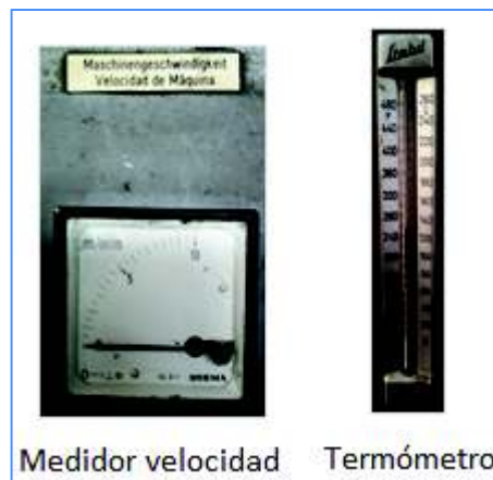
Figura 1.10. Indicador de velocidad analógico para ajuste de velocidad lineal y termómetro de cristal mercurio para verificar temperatura del horno
