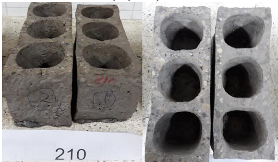
FOTOGRAFÍA 37. BLOQUES IRREGULARES OBTENIDOS POR MEDIO DEL MÉTODO 1- ACI 211.2.
