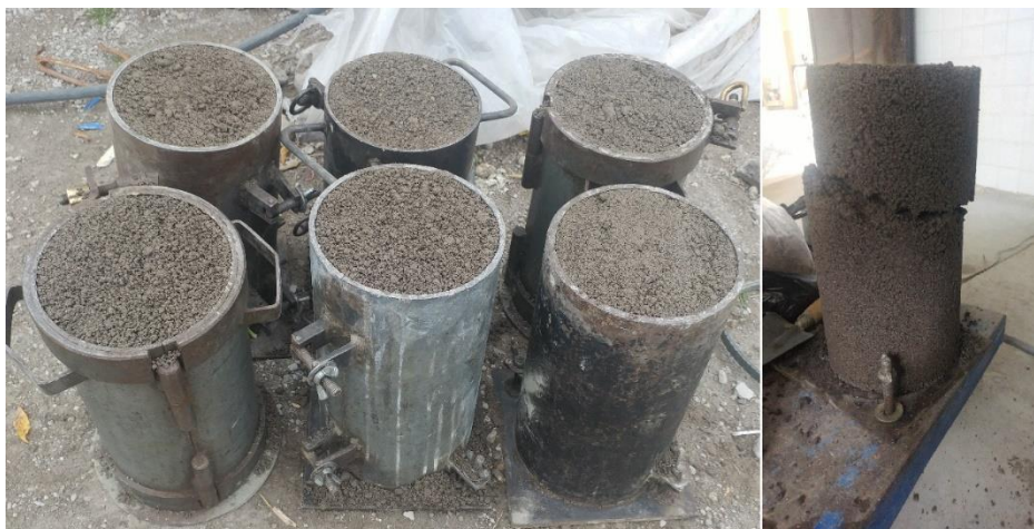
FOTOGRAFÍA 38. CONSISTENCIA ADECUADA DE LA MEZCLA, PERO IMPOSIBLE PARA FORMAR CILINDROS.
