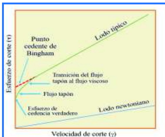
FIGURA 2. 20. DIAGRAMA DE FLUJO DEL LODO NEWTONIANO Y EL LODO TÍPICO
