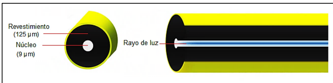
Figura 1.9 Modo de propagación de una fibra óptica monomodo [21]
