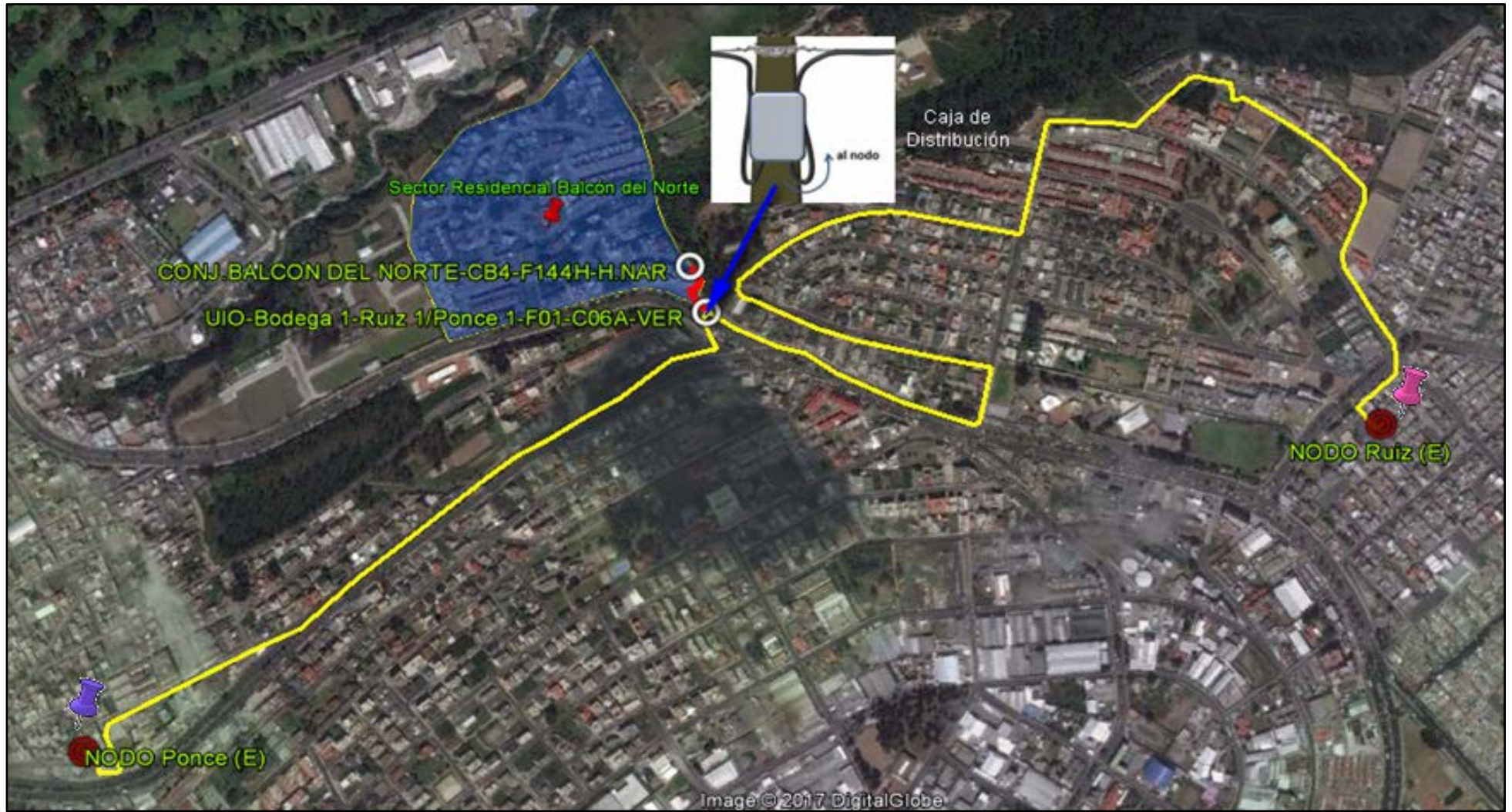
Figura 2.35 Conexión entre nodos Ponce y Ruiz [100]
