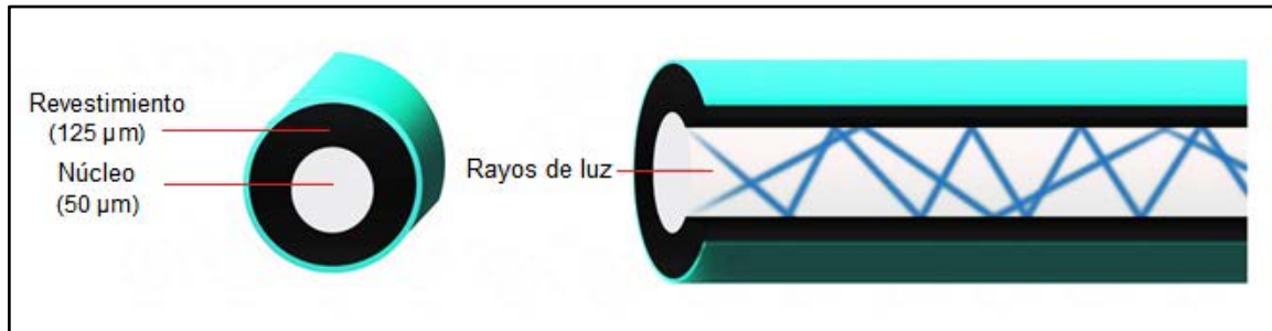
Figura 1.10 Modo de propagación de una fibra óptica multimodo [21]
