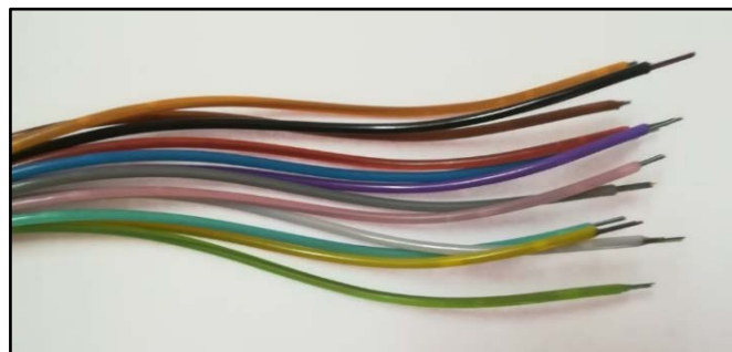
Figura 2.50 Buffers o tubos de fibra óptica de 144 hilos
