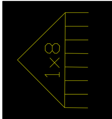
Figura 2.49 Representación del splitter 1x8
