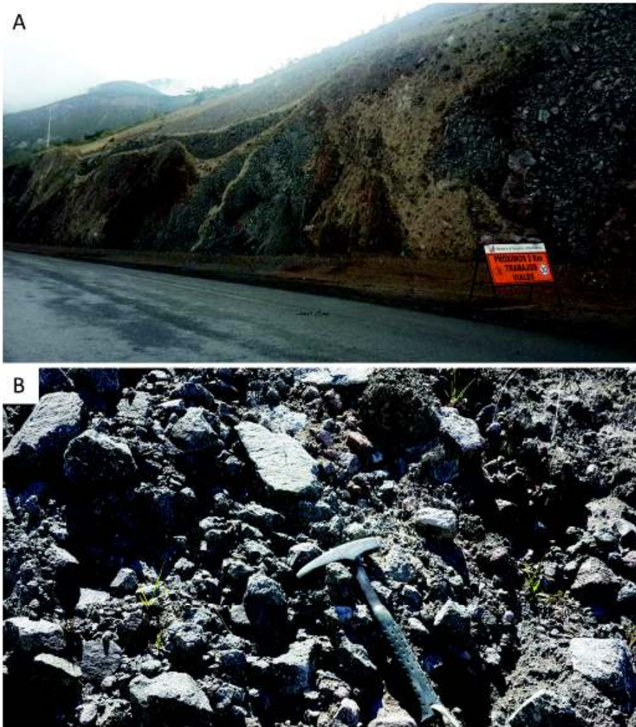
Figura 3. 11.- A y B.- Afloramiento de brechas volcánicas de coloración a gris con tonalidades rojizas de tipo clasto soportada con bloques de hasta 2 m de andesitas piroxénicas en el sector de Imbaya correspondientes a los volcánicos Imbabura (UTM: 818 637 E; 100 43 593 N).
