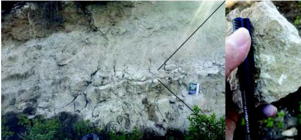
Figura 3.13.- Afloramiento de Cangahua estratificados con bioturbación y presencia de arcillas secundarias, sector Yahuarcocha (UTM: 823 886 E; 100 42 385 N)
