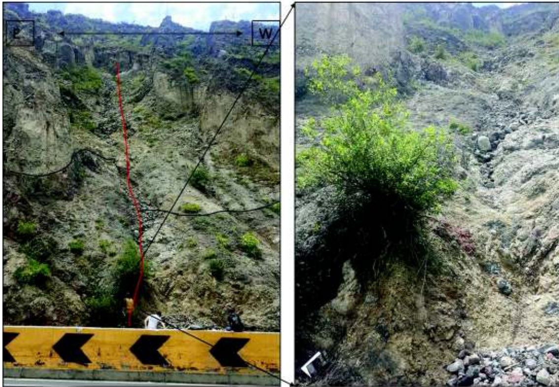
Figura 4. 7.- Afloramiento de depósitos de Debris Flow afectados por falla de tipo inversa con dirección ° 70/ 85° en azimut de buzamiento.
