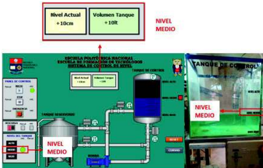
Figura 3.52 Control del Sistema de Nivel mediante la HMI.
