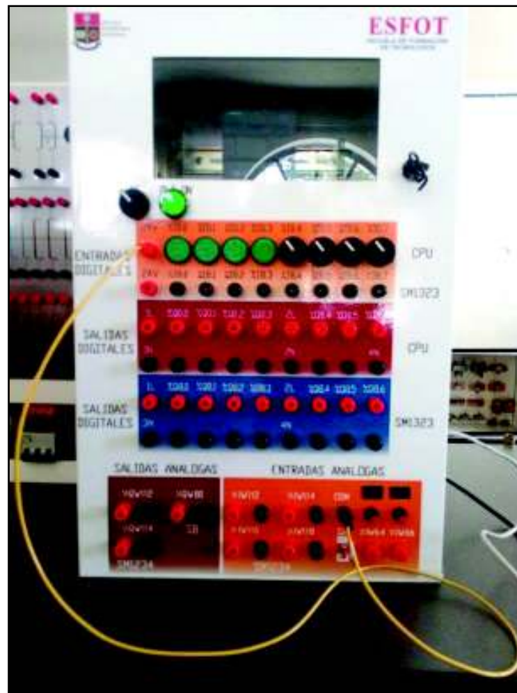
Figura 3.42 Prueba de cortocircuito en CC del módulo PLC.
