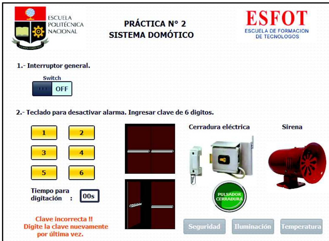
Figura 3.28 Pantalla principal del Sistema de Seguridad Domótico.
