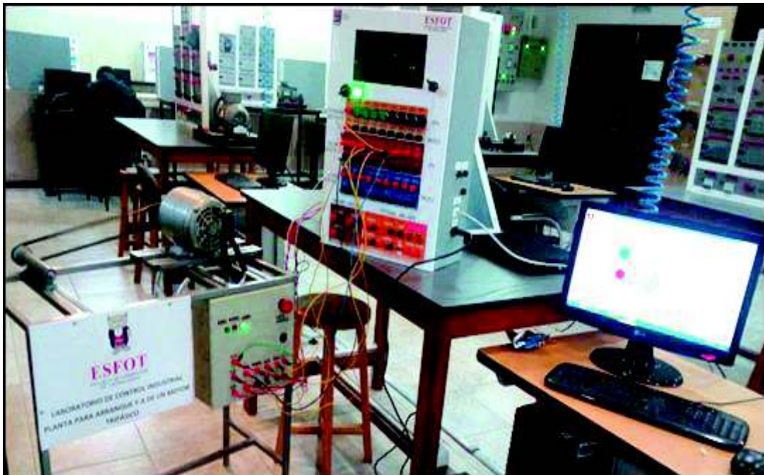
Figura 3.59 Sistema de Arranque Y-Delta funcionando correctamente.
