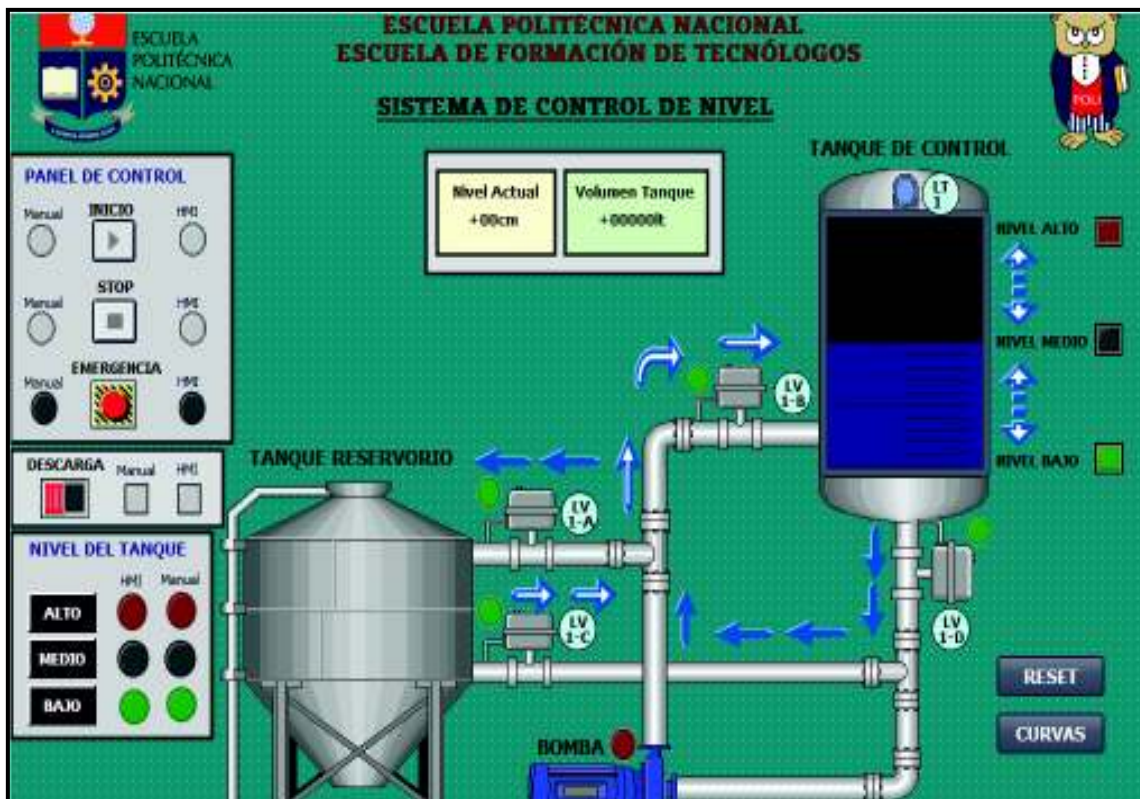
Figura 3.26 Pantalla principal del Sistema de Control de Nivel.
