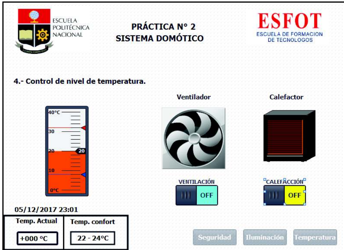
Figura 3.30 Pantalla para el control de temperatura.
