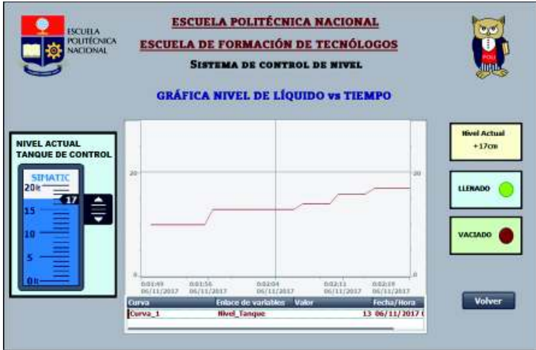
Figura 3.53 Variación en el tiempo de la señal del transmisor de nivel.
