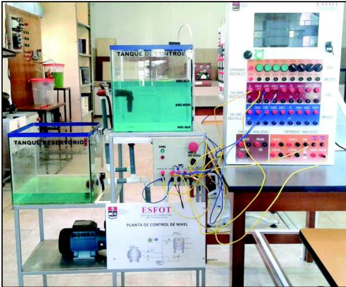
Figura 3.48 Funcionamiento del Sistema de Control de Nivel.
