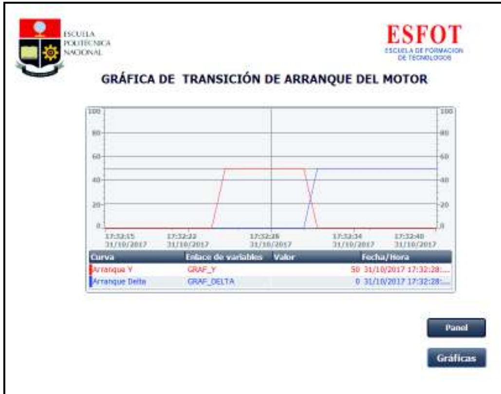
Figura 3.60 Curvas de la transición Y-Delta de un motor trifásico.
