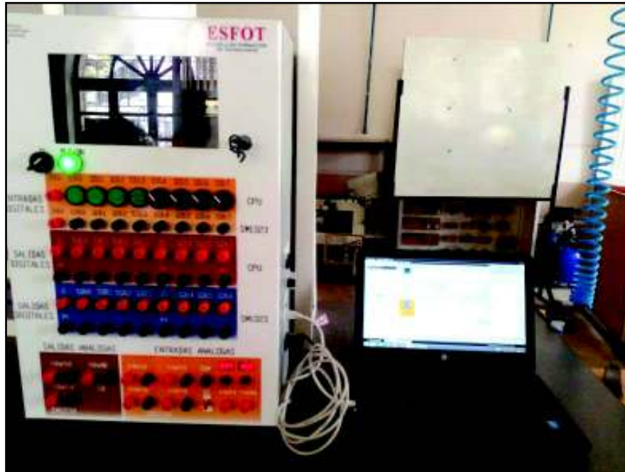
Figura 3.43 Prueba de comunicación entre el PLC S7-1200 y la PC.
