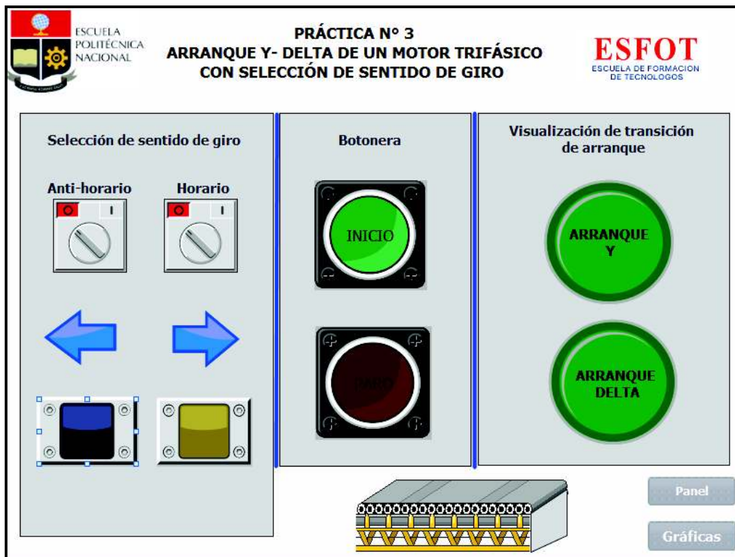
Figura 3.31 Pantalla principal para controlar el arranque de un motor trifásico.
