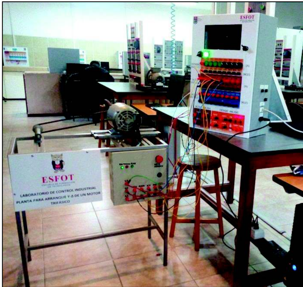
Figura 3.50 Funcionamiento del Sistema de Arranque Y-Delta.
