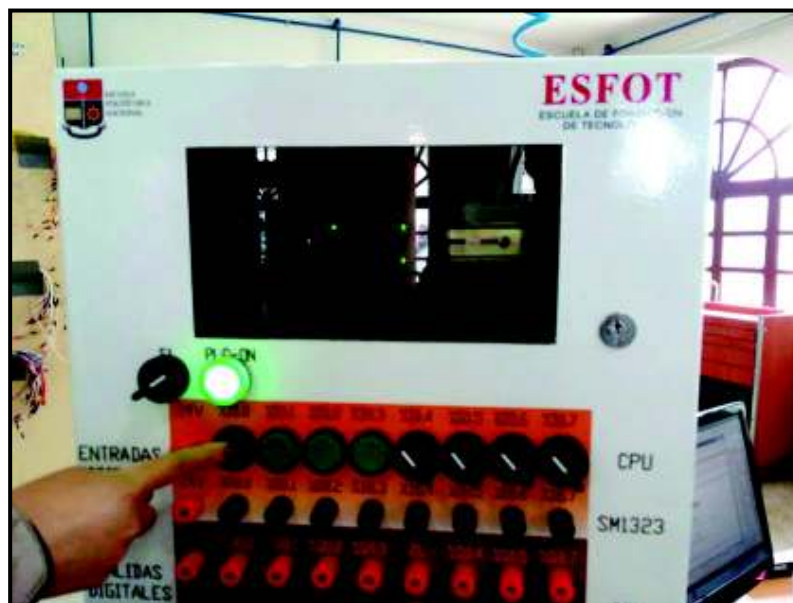
Figura 3.41 Prueba del circuito de mando del módulo PLC.
