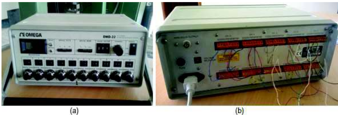
Figura 2.45. (a) Medidor de deformaciones unitarias (parte frontal), (b) Medidor de deformaciones unitarias (parte posterior). (Fuente: Laboratorio de mecánica de materiales ESPE)
