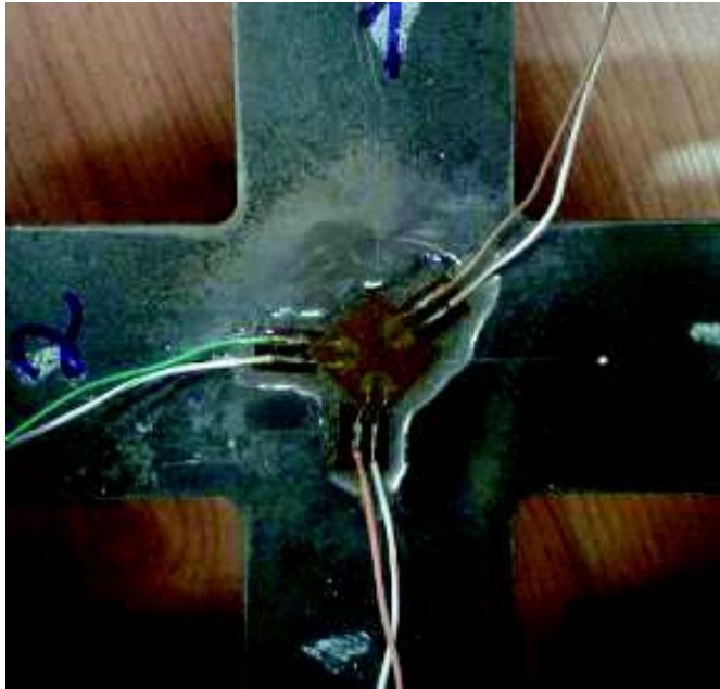
Figura 2.42. Galga ubicada en la probeta de ensayo. (Fuente: Propia)
