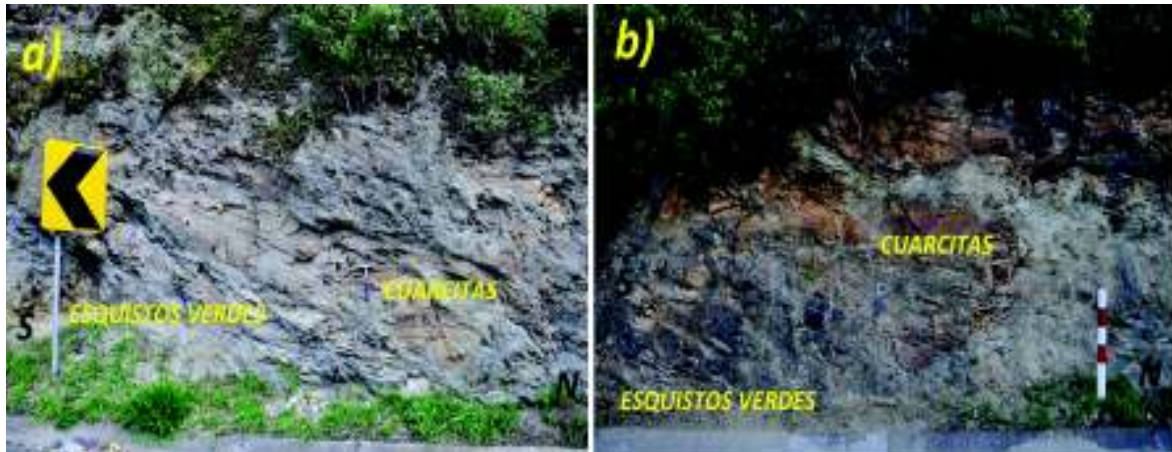
Figura 3.11. Unidad Alao-Paute. Afloramiento ubicado en la vía Baños- Ambato [AL-14 UTM: 780_{294} / 9846_{023} ], que consiste en una secuencia metamórfica de esquistos verdes intercalados con cuarcitas que presentan asociaciones y acumulaciones de cuarzo en medio de su distribución mineral.
