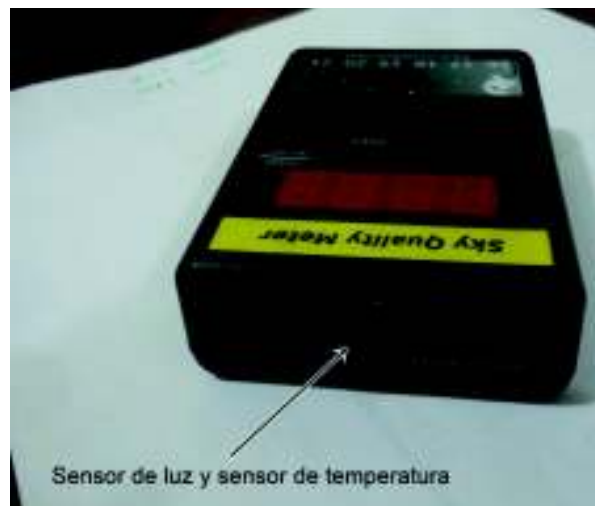
Figura 4.2. Lente de medición del SQM-L.
