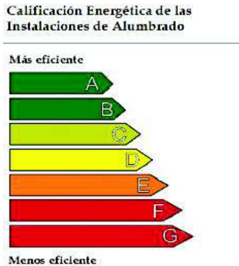
Figura 2.32. Calificación Energética de las Instalaciones de Alumbrado.
