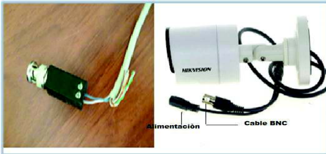
Figura 20 Conexión de cable UTP a balun y cámara
