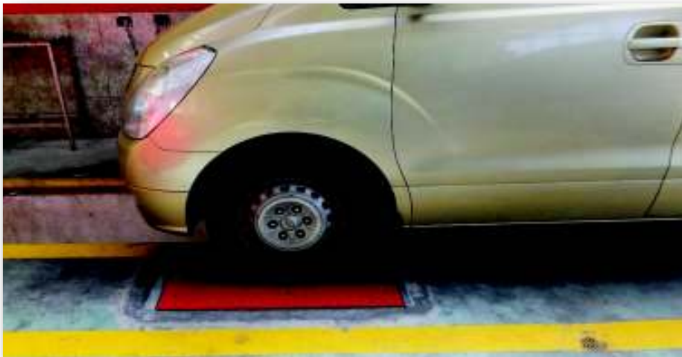
Figura 3.70. Diagnóstico de convergencia, para vehículo sin defecto de alineación de convergencia Fuente: Propia
