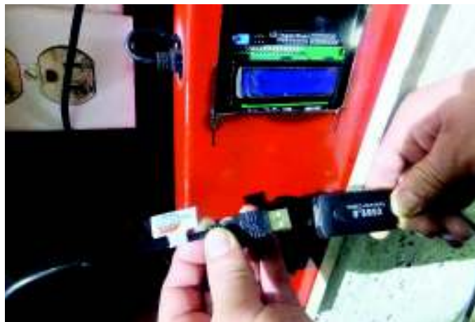
Figura 3.65. Conector USB de la tarjeta debe conectarse a USB2.0 del computador. Fuente: Propia
