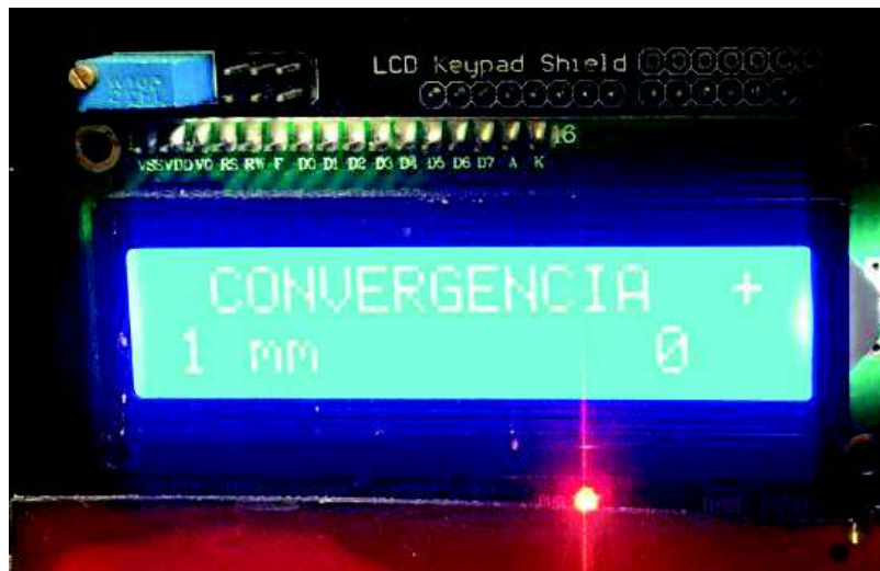
Figura 3.72. Diagnóstico de salida para el vehículo, luego de corregido el defecto de convergencia Fuente: Propia
