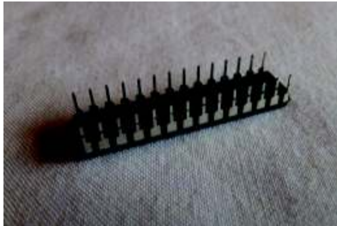
Figura 2.38. Micro controlador ATMEGA 328P-PU Fuente: www.atmel.com
