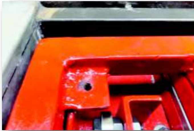
Figura 3.29. Placas de sujeción para fijar plataforma superior Fuente: Propia
