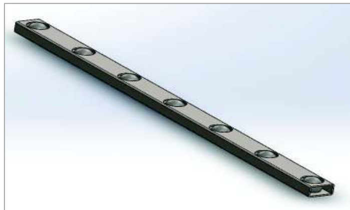
Figura 3.17. Diagrama para riel de deslizamiento antifricción Fuente: Propia
