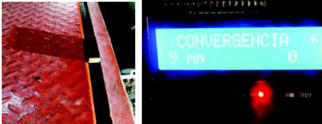
Figuras 3.68. Desplazamiento de la plataforma hacia la izquierda, es convergencia positiva. Fuente: Propia
