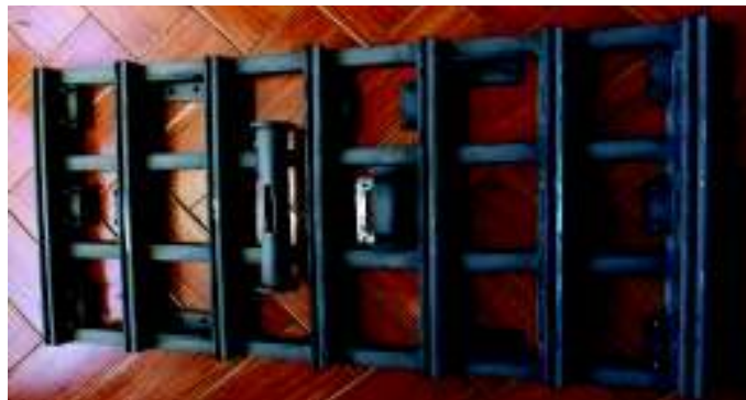
Figura 3.15. Soportes para anclaje de elementos, de la sección 1.1
