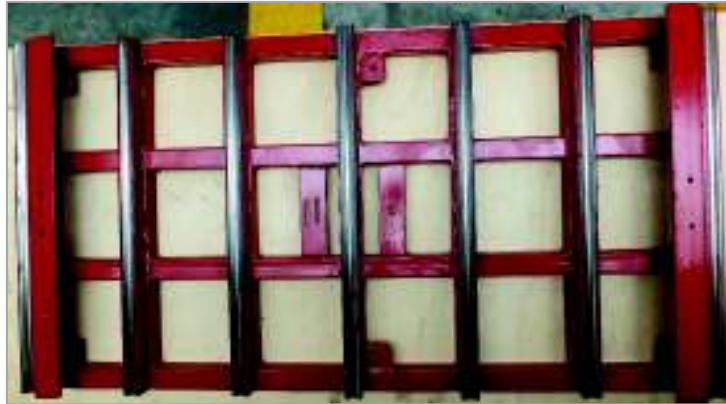
Figura 3.23. Barras superiores de deslizamiento Fuente: Propia
