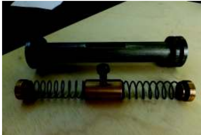
Figura 3.8. Mecanismo central de vaivén construido Fuente: Propia
