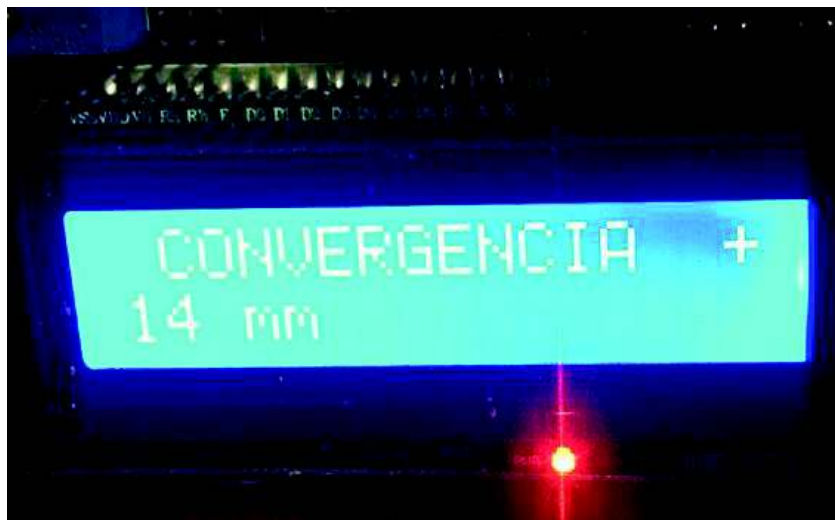
Figura 3.71. Diagnóstico de entrada, para vehículo con defecto de convergencia Fuente: Propia
