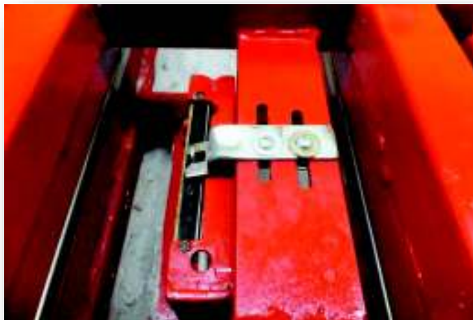
Figura 3.28. Conexión de la sección móvil 1.3 al sensor de desplazamiento Fuente: Propia
