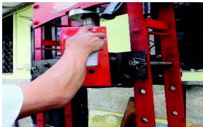
Figura 3.55. Prensa hidráulica, enderezamiento de deformaciones de soldadura Fuente: Propia
