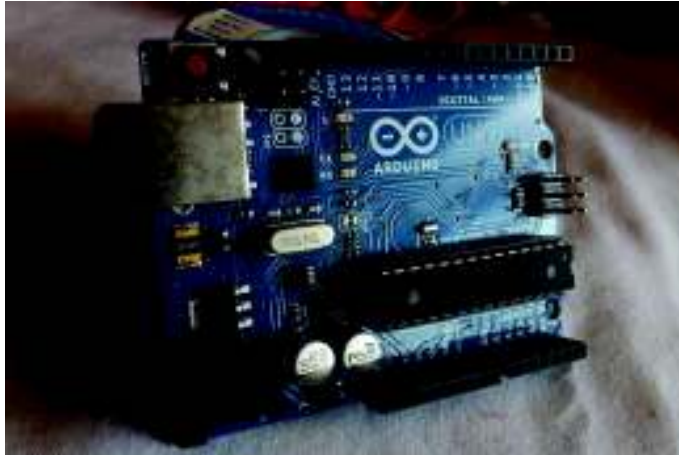
Figura 2.39. Tarjeta ARDUINO 1, con micro controlador Fuente: www.arduino.com [20]
