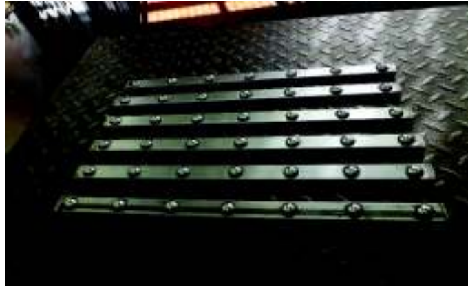
Figura 3.18. Conjunto de rieles antifricción Fuente: Propia
