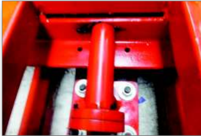
Figura 3.26. Apoyo del encerador sobre la barra de seguridad. Fuente: Propia
