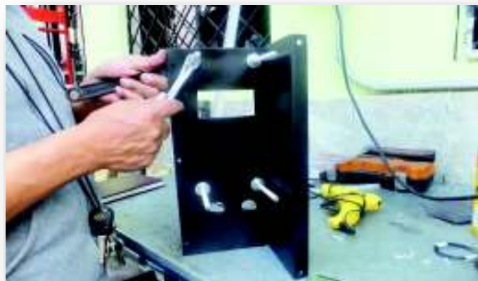
Figura 3.48. Vista interior de la caja de control con pilares de apoyo Fuente: Propia
