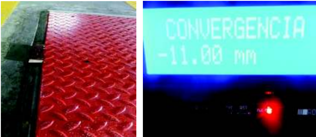
Figuras 3.67. Desplazamiento de la plataforma hacia la derecha, es convergencia negativa. Fuente: Propia
