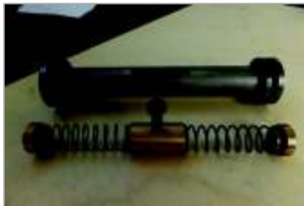
Figura 2.7. Solución del módulo 3, encerador mecánico Fuente: Propia.
