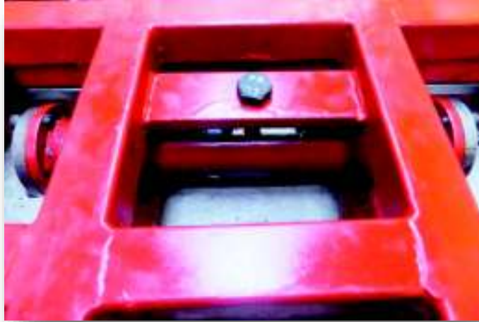
Figura 3.27. Conexión de la sección 1.3 al mecanismo de vaivén Fuente: Propia
