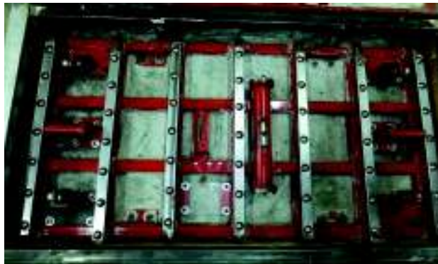
Figura 3.56. Siete rieles para anclaje de esferas de rodamiento. Fuente: Propia
