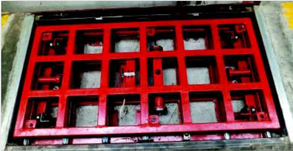
Figura 3.32. Ensamblaje mecánico del equipo, sin la plataforma superior Fuente; Propia
