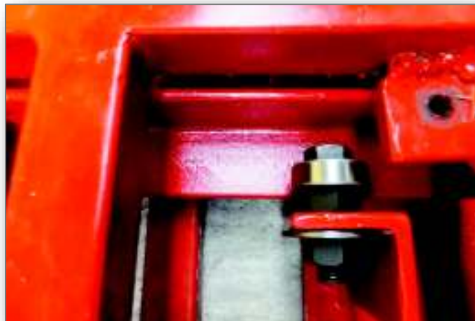
Figura 3.25. Elemento anti torque sobre la barra de seguridad. Fuente: Propia
