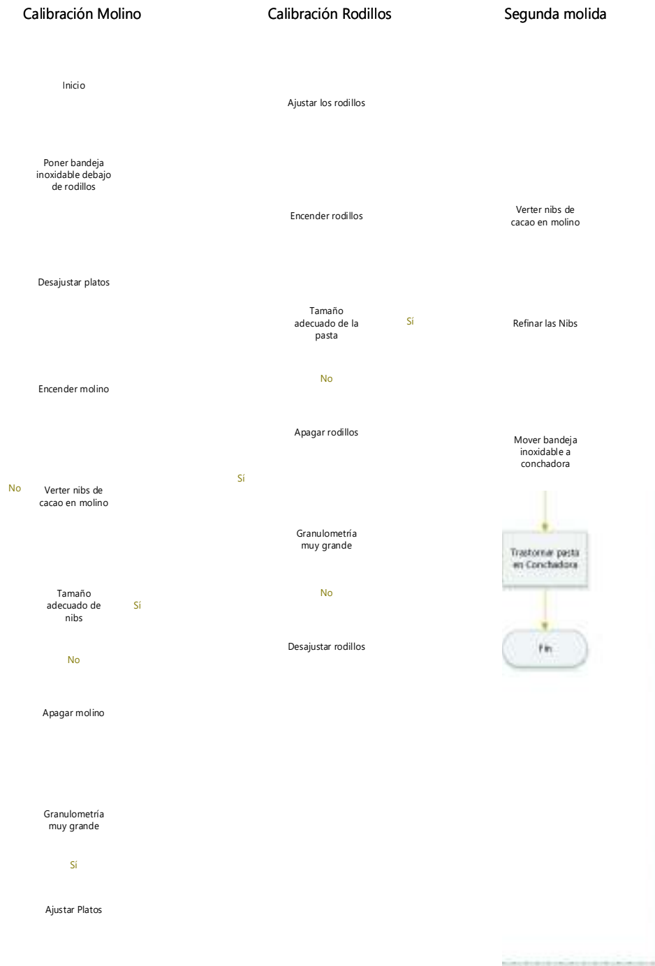
Figura 3.24. Diagrama de flujo del nuevo método desarrollado para el Proceso de Refinado
