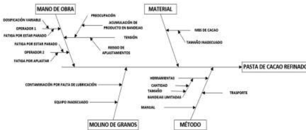
Figura 3.4. Diagrama de pescado del proceso de refinado
