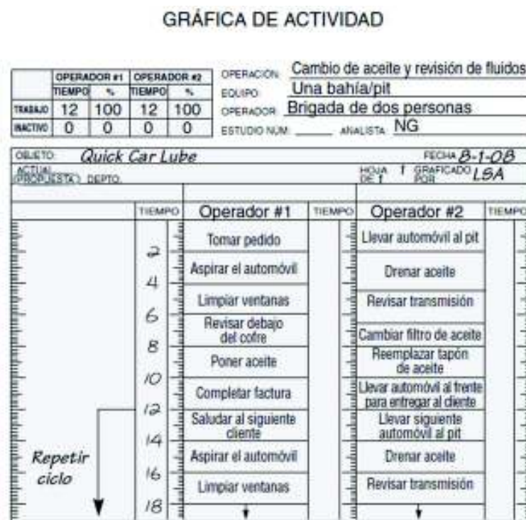
Figura 1.4. Diagrama de actividades de un equipo de dos personas que realiza un cambio de aceite en 12 minutos en Quick Car Lube. Fuente: p. 500.
