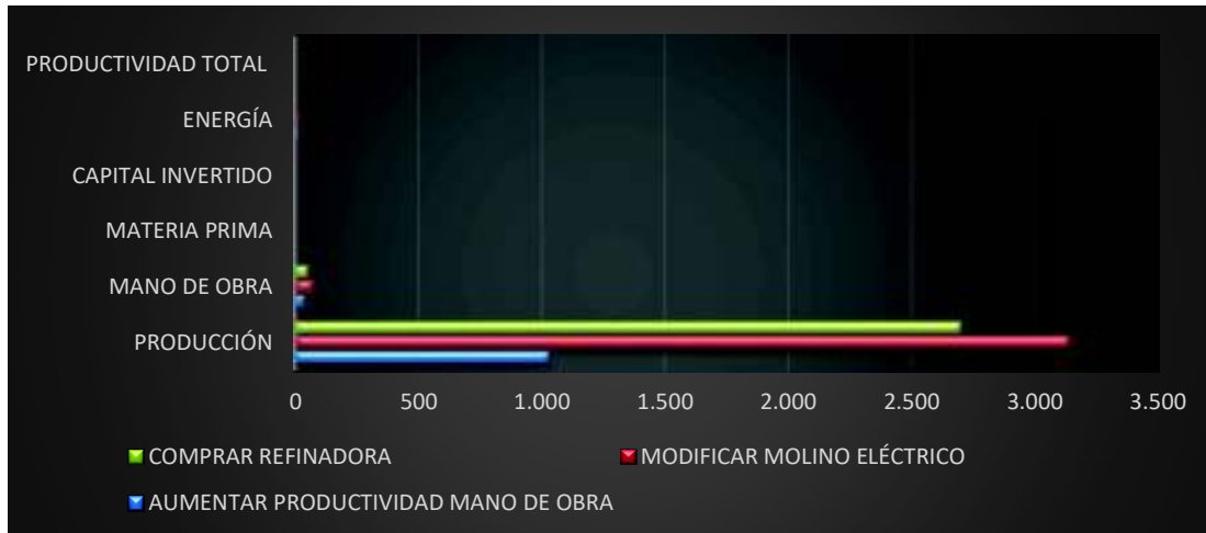
Figura 3.45. Gráfica comparativo resumen de las productividades para las tres propuestas de mejora del proceso de refinado
