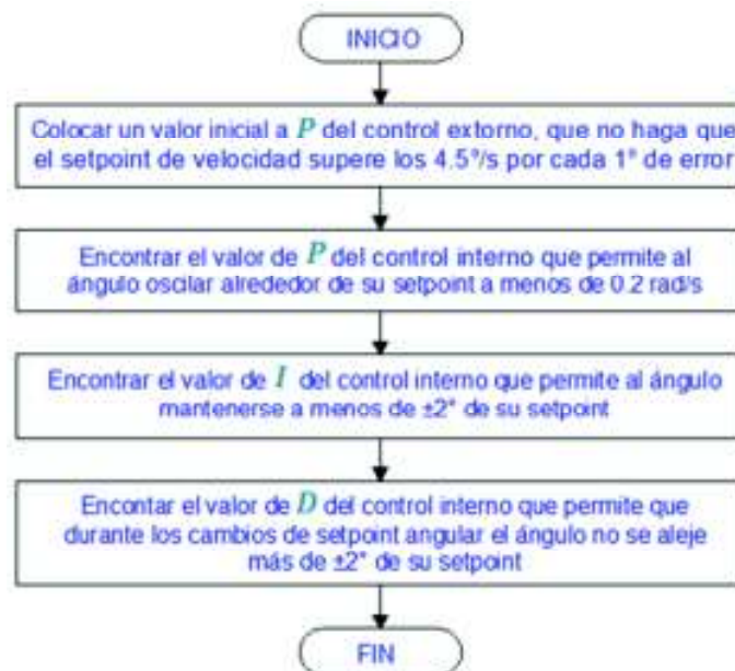
Figura 2.25. Procedimiento de sintonización del control PID.
