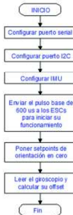
Figura 2.4. Flujograma de la función void setup ().
