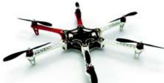
Figura 1.5. Estructura del hexarotor DJI F550.
