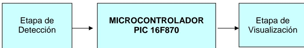
**Figura 2.1. Diagrama de bloques del prototipo de parqueadero**
