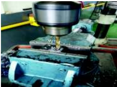
Figura 3. Taladrado de los elementos.
