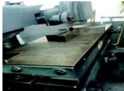
Figura 4. Rectificado de los elementos.
