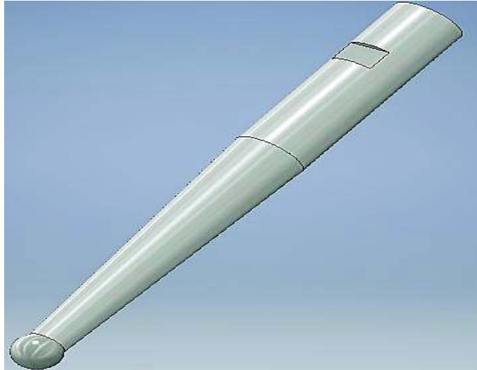
Figura 2. 10. Herramienta cónica con punta esférica. (Fuente: Propia)
