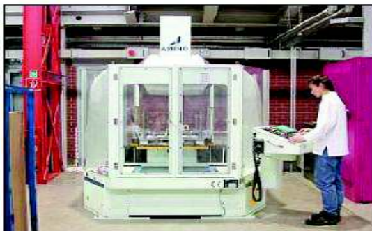
Figura 1. 12. Maquinaria para desarrollar SPIF. (Fuente: [9])
