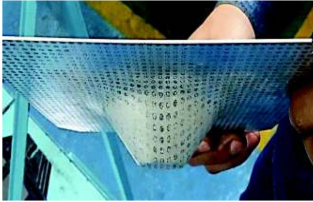
Figura 2. 46. Fabricación de pieza modelo mediante SPIF. (Fuente: Propia)
