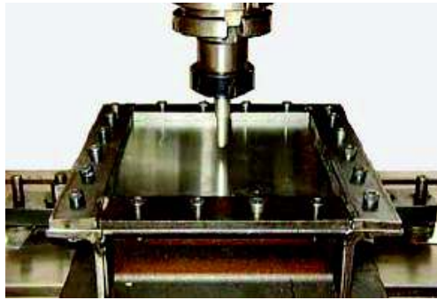
Figura 1. 11. Utillaje de sujeción de la chapa. (Fuente: [8])
