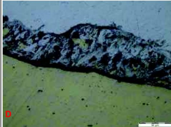
Figura D. Zona de unión de las probetas Latón-Aluminio, entre Z1 y Z2, se observa incrustaciones de latón en el aluminio. Aumento 500x sin ataque químico.
