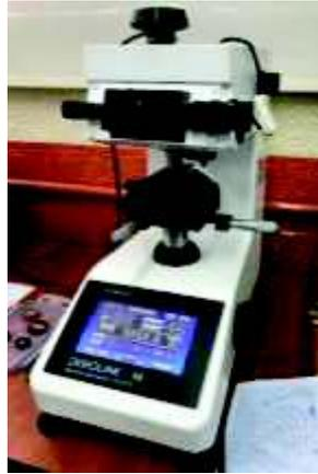
Figura 2.17. Microdurómetro marca Metkon.
