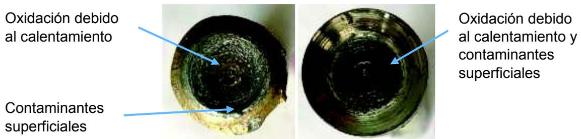
Figura 3.13. Material plastificado concentrado de la junta 9; probeta de latón (izquierda) y aluminio (derecha).
