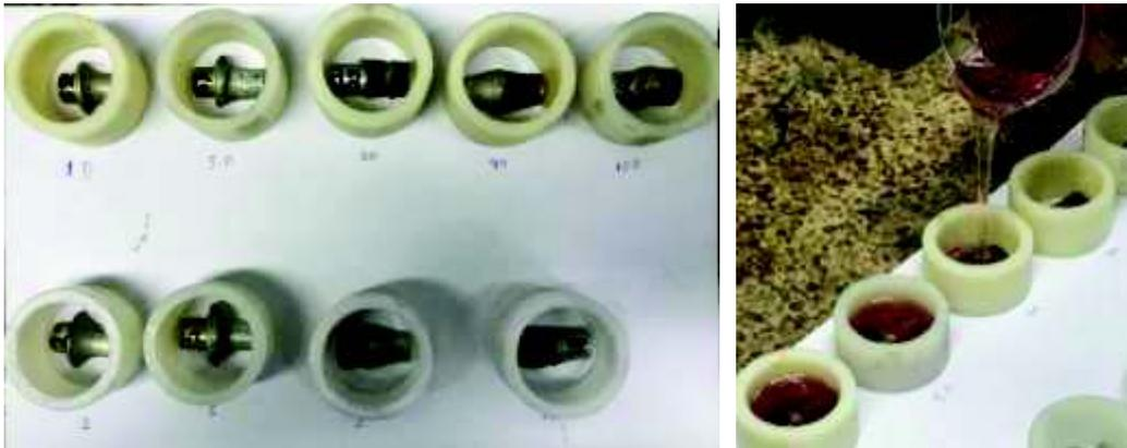
Figura 2.14. Montaje de las muestras en resina.
