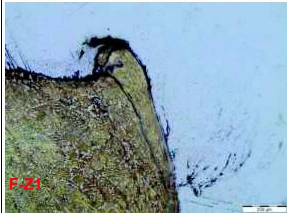
Figura F-Z1. Zona de unión de las probetas Latón-Aluminio, se observa una forma de grano regular. Aumento 100x con ataque químico al latón.
