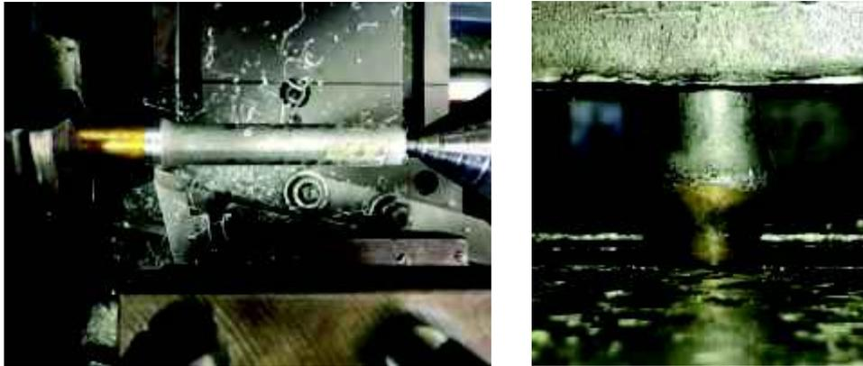
Figura 2.11. Eliminación del flash (izquierda) y ensayo de tracción (derecha).
