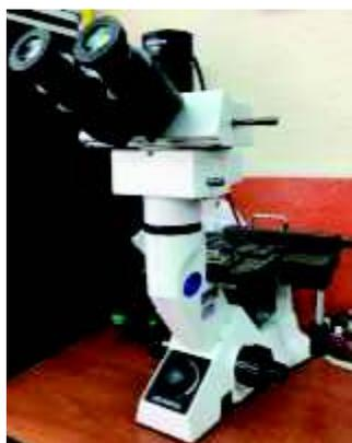
Figura 2.16. Microscopio metalográfico OLYMPUS GX41.
