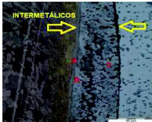
Figura 3.26. Zona de intermetálico.
