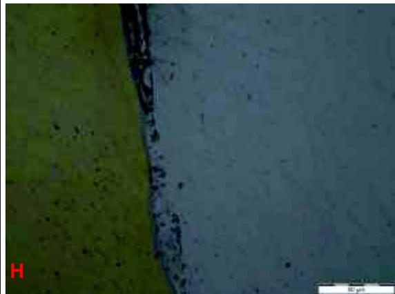
Figura H. Zona de unión de las probetas Latón-Aluminio, se observa grietas cerca de la zona de coalescencia, fragmentos de latón en el aluminio y una delgada zona de coalescencia. Aumento 500x sin ataque químico.
