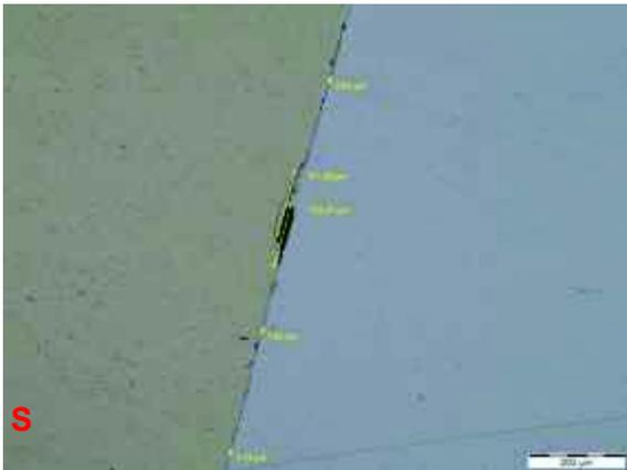
Figura S. Zona de unión de las probetas Latón-Aluminio, se observa una unión incompleta y grietas en la interfaz. Aumento 100x sin ataque químico.
