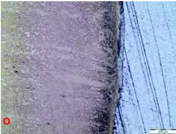
Figura O. Zona de unión de las probetas Latón-Aluminio, se observa el tamaño de grano del latón, la zona de coalescencia con presencia de material deformado y la zona afectada por el calor. Aumento 100x con ataque químico al latón.
