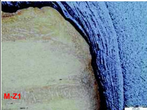
Figura M-Z1. Zona de unión de las probetas Latón-Aluminio, se observa distinta coloración y forma del grano cerca de la unión. Aumento 100x con ataque químico al latón.
