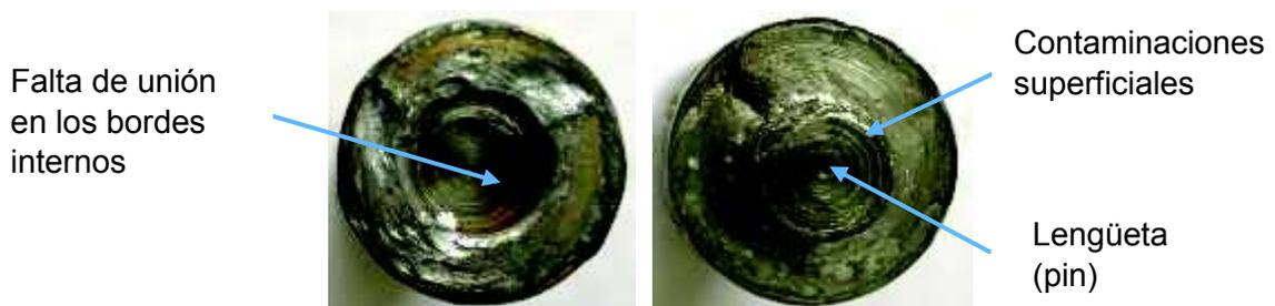
Figura 3.14. Material plastificado concentrado de la junta 4D; probeta de latón (izquierda) y aluminio (derecha).
