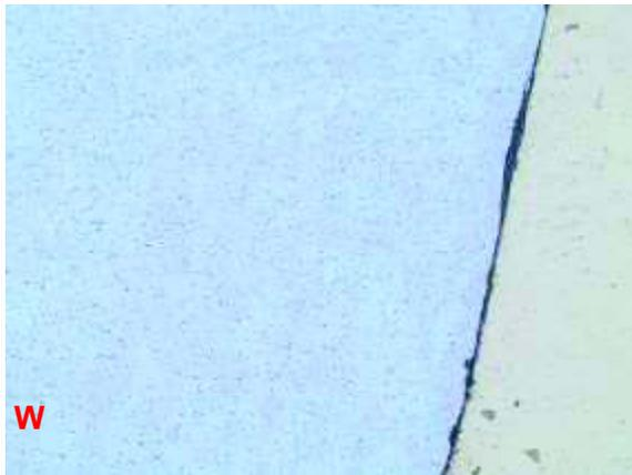
Figura W. Zona de unión de las probetas Latón-Aluminio, se observa una falta de unión a lo largo de la junta soldada. Aumento 100x con ataque químico al aluminio.
