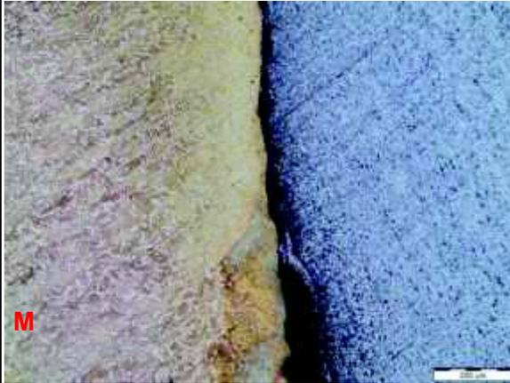
Figura M. Zona de unión de las probetas Latón-Aluminio cerca de Z4, se observa incrustaciones de aluminio en el latón y una diferencia en el color del grano en el latón. Aumento 100x con ataque químico al latón.
