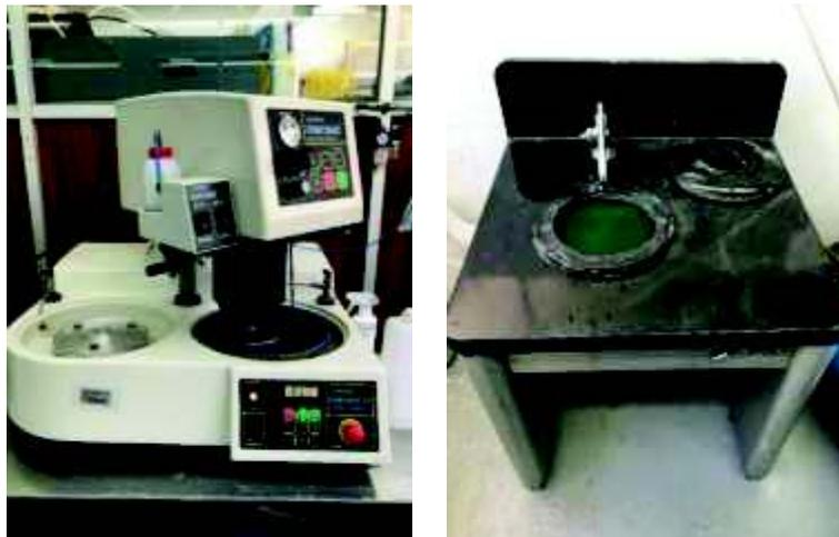
Figura 2.15. Equipos FORCIMAT, FORCIPOL (izquierda) y máquina de pulido (derecha).
