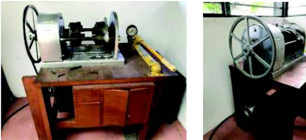
Figura 2.5. Máquina de soldadura por fricción de conducción directa/continua.
