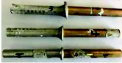
Figura 3.11. Probetas soldadas de junta simple.
