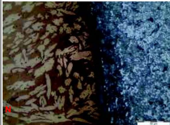
Figura N. Zona de unión de las probetas Latón-Aluminio entre Z2 y Z3, se observa no hay cambio de grano del latón. Aumento 500x con ataque químico al latón.
