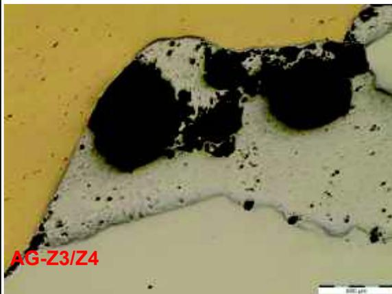
Figura AG-Z3/Z4. Zona de unión de las probetas Latón-Aluminio, se observa cambio en superficie del aluminio con grietas en las esquinas. Aumento 50x sin ataque químico.
