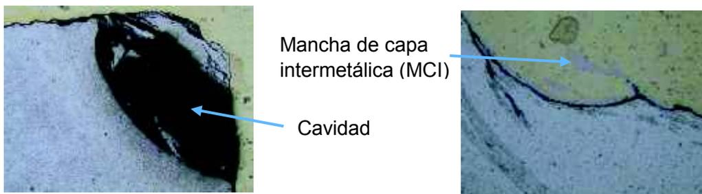
Figura 3.22. Defectos y capas intermetálicas de la junta 5D.
