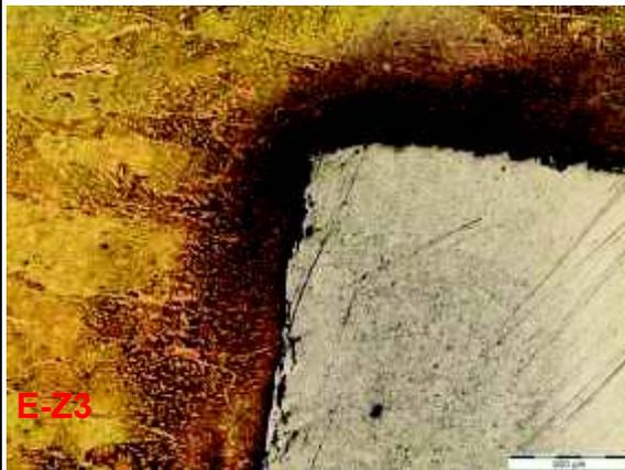
Figura E-Z3. Zona de unión de las probetas Latón-Aluminio, se observa un cambio de coloración cerca de la unión. Aumento 50x con ataque químico al latón.
