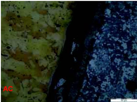
Figura AC. Zona de unión de las probetas Latón-Aluminio cerca de Z4, se observa la forma del grano del latón cerca de la interfaz. Aumento 500x con ataque químico al latón.
