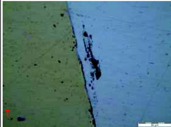
Figura T. Zona de unión de las probetas Latón-Aluminio, se observa poca coalescencia con grietas en la interfaz. Aumento 500x sin ataque químico.
