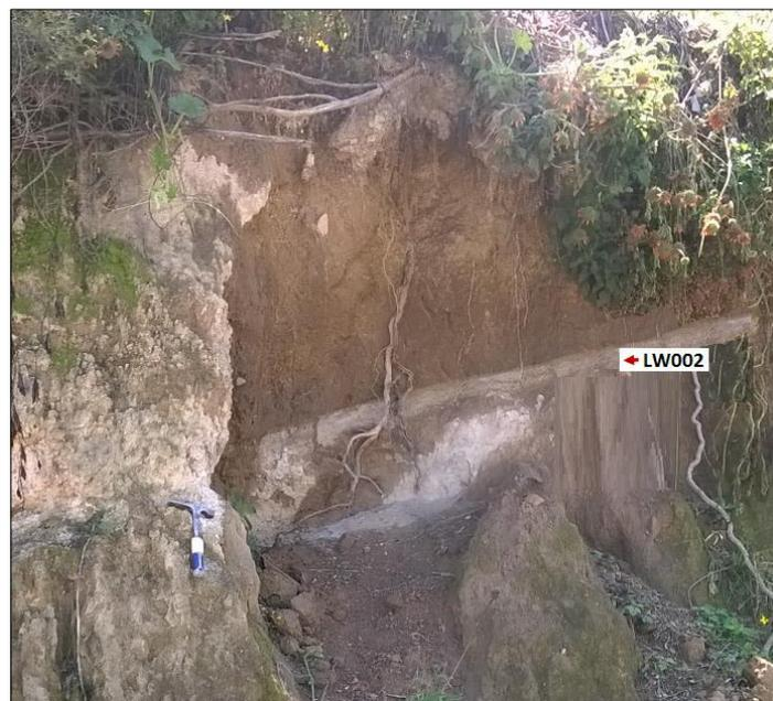
**Fotografía 3.4** Identificación de la capa LW002 en el camino del alcantarillado. UTM
